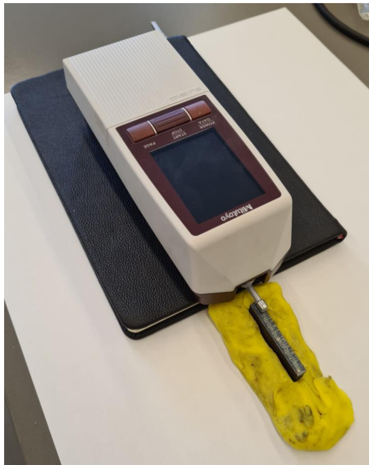
Figura 74 - Medição da rugosidade da superfície de corte ( Rz_5 ).
