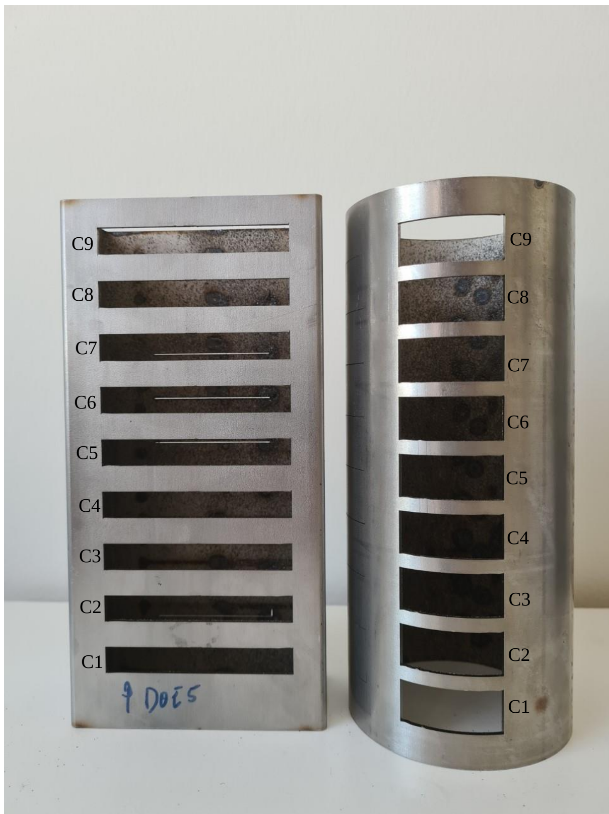
ANEXO 3: Tubos aço inoxidável (AISI 304), 2 mm de espessura, secção retangular (100x50 mm) e secção circular (Ø88.9 mm).
