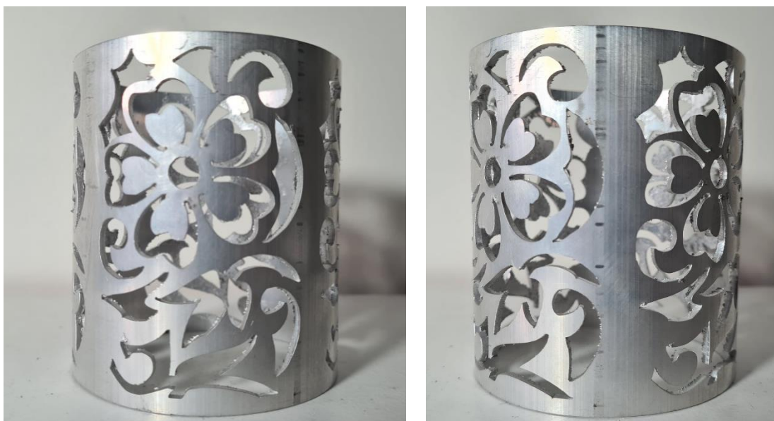
Figura 101 – Cortes complexos realizados em alumínio com 2 mm de espessura, utilizando a combinação de parâmetros definida como ótima.
