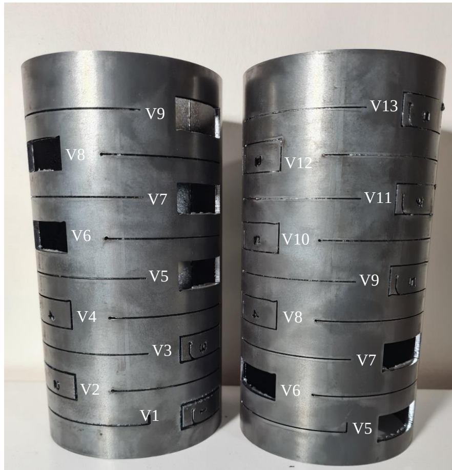
Figura 78 - Cortes realizados com incremento de velocidade (Aço estrutural, 3mm de espessura). V1 = 0.5 m/min; V13 = 6.5 m/min; Incremento = 0.5 m/min.
