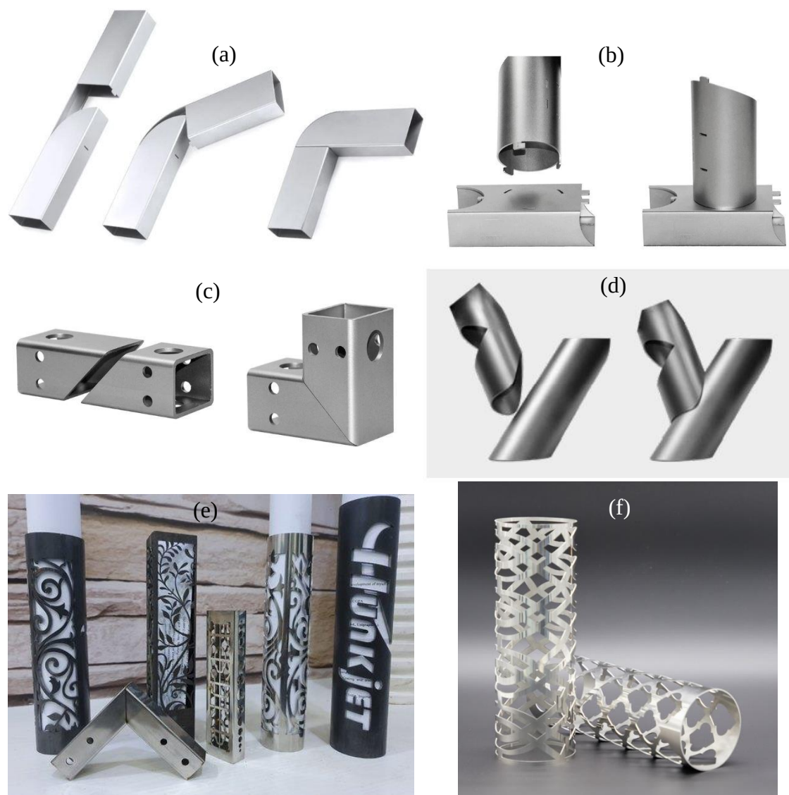
Figura 62 - Aplicações do corte a laser de tubos. (a) - Ligação curvada (TRUMPF 2021); (b) - Encaixe (TRUMPF 2021; Jensen e Petersen 2012); (c) e (d) - Corte em chanfro para posterior aplicação de soldadura (TRUMPF 2021); (e) e (f) - Componentes estéticos (Hunkjet Technocraft 2019).
