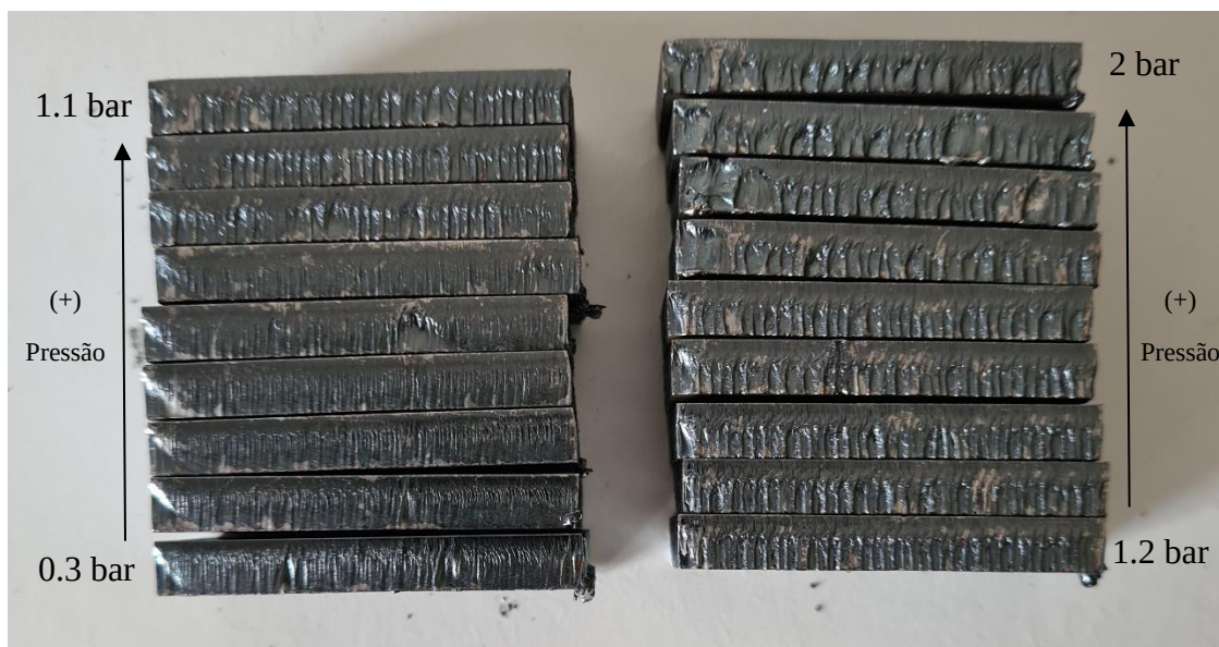
Figura 79 - Superfícies de corte. Testes de incremento da pressão do gás de assistência (Aço estrutural, 6mm de espessura, tubo de secção retangular).
