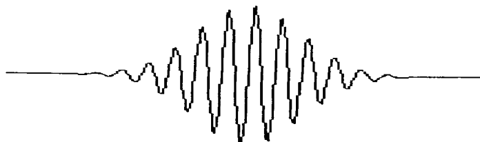
Figura 2.14: Representação esquemática de um sinal do foto detector após filtragem, "burst"
