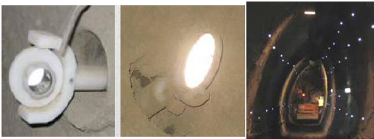
Figura 4.10. Exemplos de alvos topográficos para sensores ópticos.
