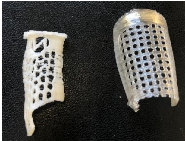
Figura 36 - Malhas produzidas com PLA (direita) e PLA com 15% de HA (esquerda)
