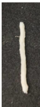
Figura 19 - Filamentos obtidos por extrusão de PLLA-HA com adição de solventes
