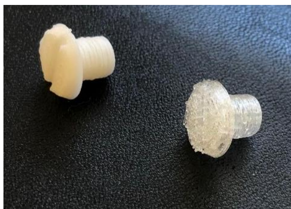
Figura 35 - Parafusos produzidos com PLA (direita) e PLA com 15% de HA (esquerda)
