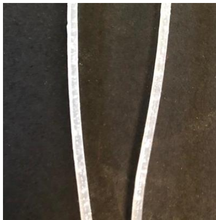
Figura 18 - Filamentos obtidos por extrusão de PLLA-HA sem adição de solventes
