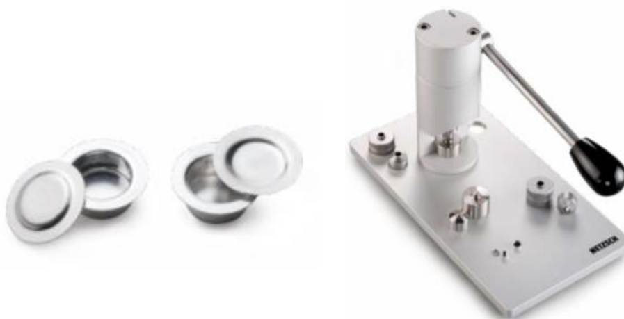
Figura 14 - Cadinhos de alumínio de fundo côncavo (esquerda). Prensa de selagem de cadinhos (direita) [70]
