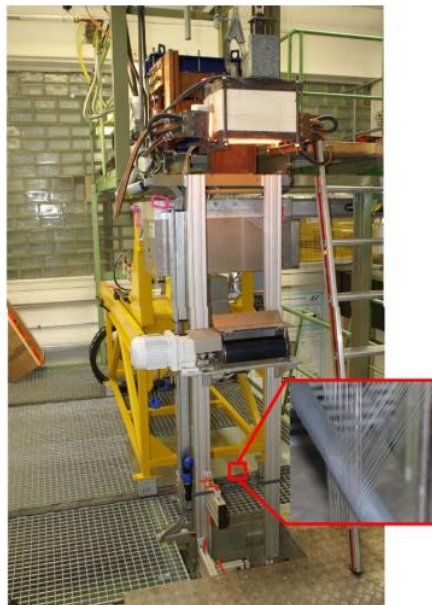
Figura 19 - Representação esquemática (esquerda) e equipamento (direita) de "online commingling" de vidro e PP. A ampliação demonstra o mistura das fibras de vidro com as de PP (filamentos que se deslocam da direita para a esquerda) (Mäder, Rausch, and Schmidt 2008)
