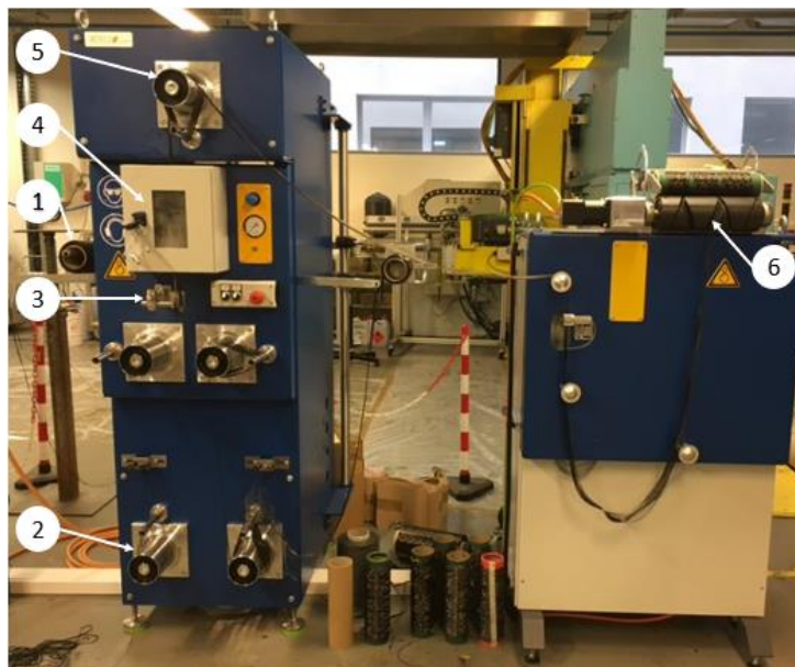
Figura 34 - Máquina de “commingling” existente, onde 1 corresponde aos suportes do rolo do fio, 2 e 5 ao conjunto de cilindros, 3 ao suporte de guiamentos, 4 à câmara de mistura e 6 ao enrolador
