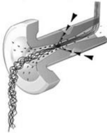
Figura 11 - Representação esquemática do funcionamento de "air-jet texturing" (Gong 2011)
