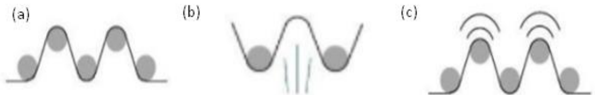
Figura 36 - Exemplificação de diferentes métodos de espalhamento, como o uso de barras de espalhamento (a), aplicação de um jato de ar (b) e uso de ultrassons (c) (Ginger Gardiner 2018)
