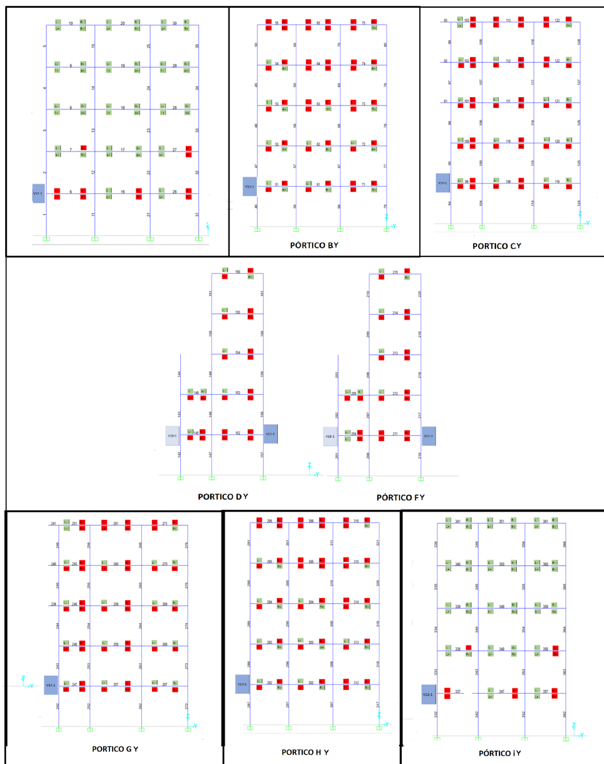
Figura 5.16 - Representação gráfica das verificações em vigas dos pórticos em Y para o mecanismo frágil realizada na folha de cálculo para combinação sísmica CQP “+” 30E2X_100E2Y.
