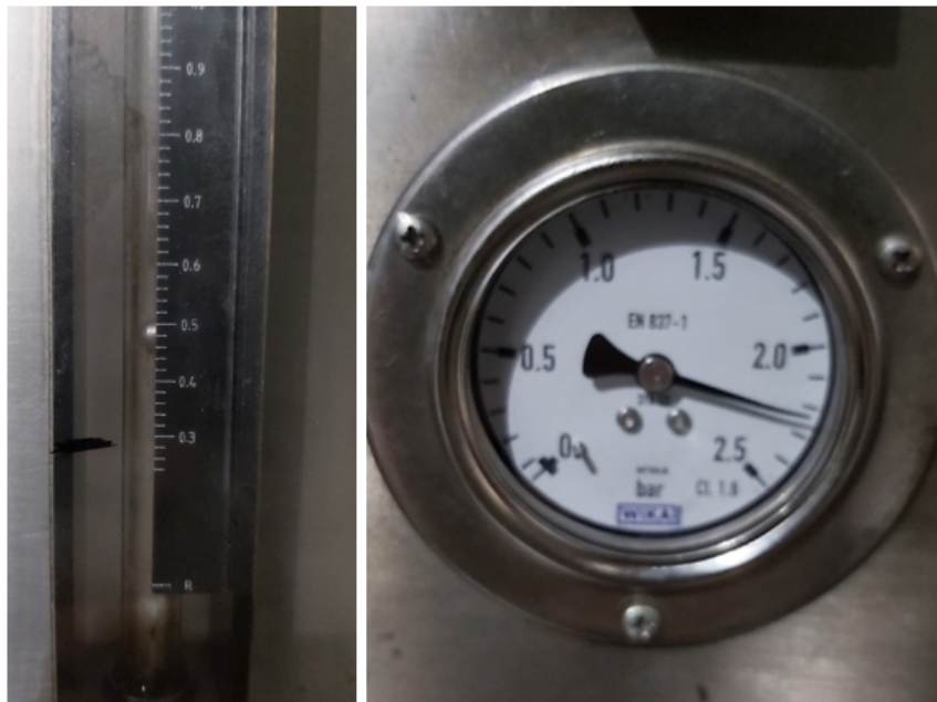
Figura 2.4: Rotâmetro e manómetro do amónia com os respetivos valores de caudal e pressão relativa.
