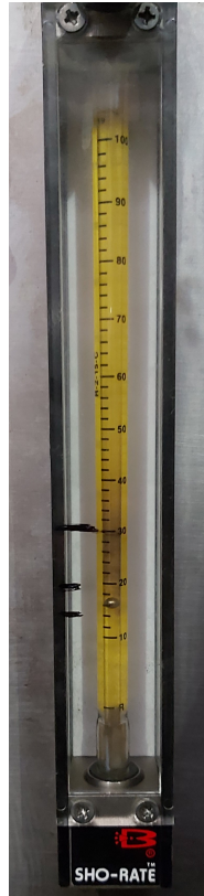
Figura 2.2: Rotâmetro usado para medição do caudal de metanol líquido.
