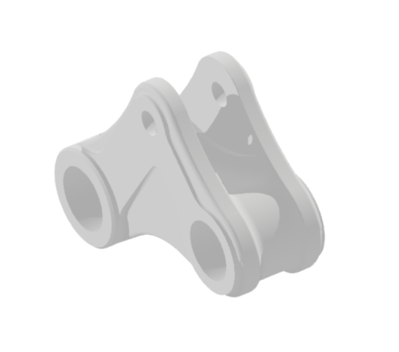
Figura 3.9: Biela de ligação ao braço da roda traseira.
