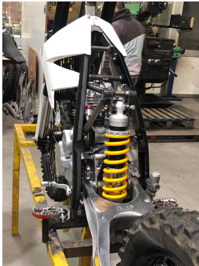
Figura 2.8: Protótipo em desenvolvimento do quadro dos modelos da PR3 e da PR4.
