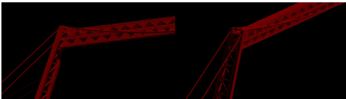
Figura 6.1 - Modelo tridimensional da ponte (perspetiva ligação tabuleiro - pilar)
