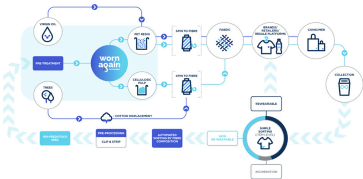
Figura 17- Diagrama de processos incluindo a tecnologia de reciclagem desenvolvida pela Worn Again Technologies
