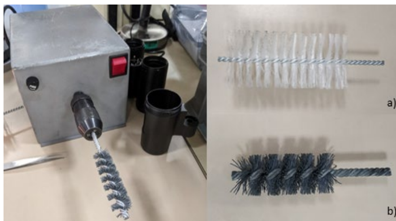
Figura 4.19 - Motor Schneider Eletric (a - Escova de nylon; b - Escova abrasiva).
