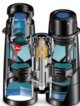
Figura 3.6 - Vista em corte do binóculo modelo Ultravid HD-Plus 7x42 [15].
