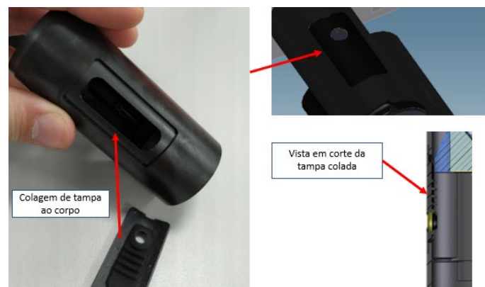
Figura 3.9 - Colagem de tampas aos corpos dos binóculos.
