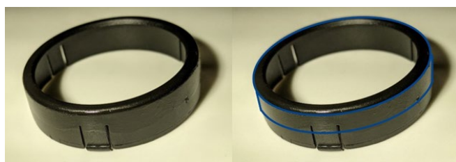
Figura 4.24 - Diafragma com planatol aplicado com pincel.
