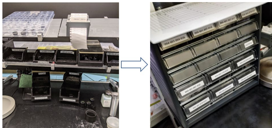
Figura 5.10 - Substituição de caixas de armazenamento com dimensões inadequadas, por armário compacto, fechado e mais organizado.
