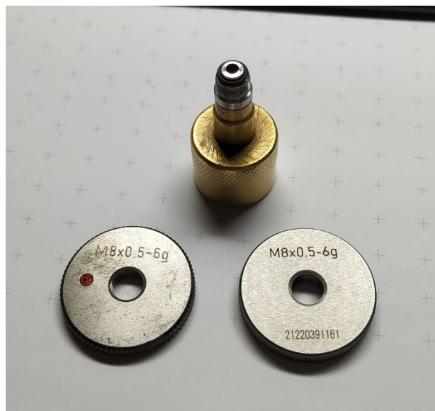
Figura 4.35 - Verificação da rosca do adaptador, com recurso a calibres de rosca em anel.
