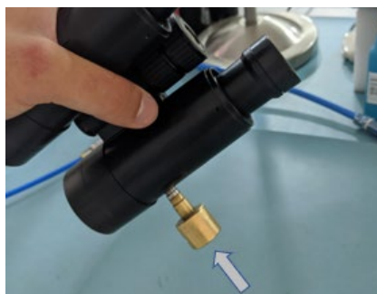
Figura 3.23 - Roscagem do adaptador ao furo roscado, existente numa metade do corpo do binóculo.
