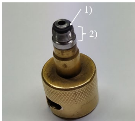
Figura 3.22 - Adaptador usado no teste de estanquidade para roscar ao corpo do binóculo (1 – O-ring de vedação; 2 – Rosca).
