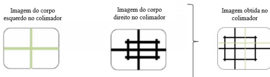
Figura 3.20 - Imagens obtidas no colimador na ajustagem binocular.
