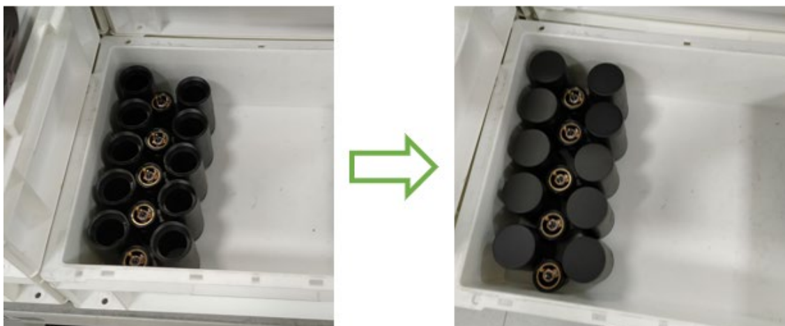
Figura 4.12 - Colocação de tampas para salvaguardar a limpeza do interior dos corpos.
