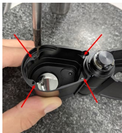
Figura 5.5 - Zonas onde vai ficar apoiado/fixado o sistema de prismas.
