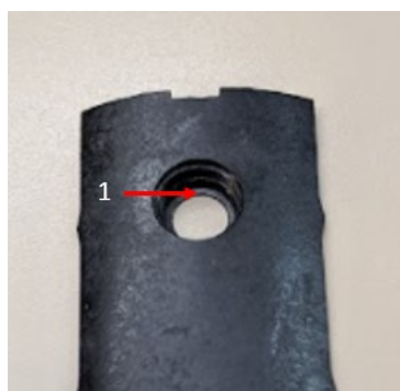
Figura 3.24 - Furo roscado existente na tampa que é colada ao corpo do binóculo (1- parede interna para esmagamento do o-ring do adaptador).
