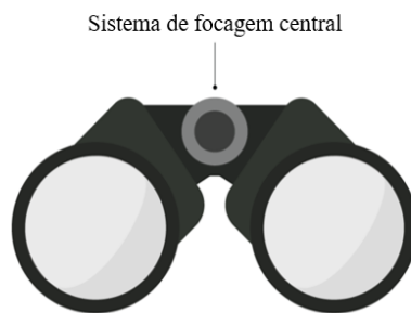
Figura 2.9 - Sistema de focagem central (adaptado de [13]).
