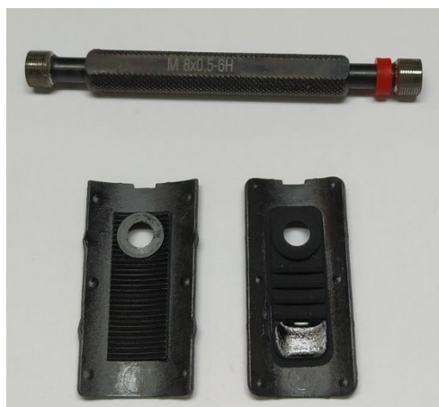
Figura 4.32 - Verificação da tolerância do furo roscado, usando calibres de rosca.
