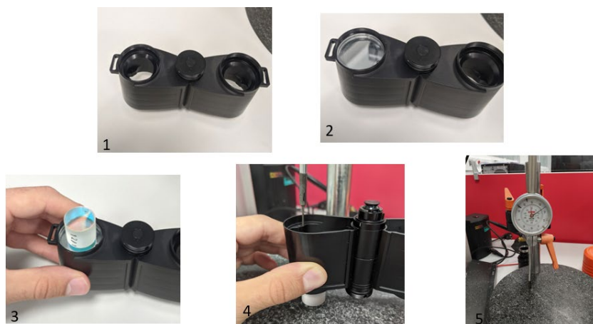
Figura 5.7 - Procedimento para medição de cotas dos corpos dos binóculos.
