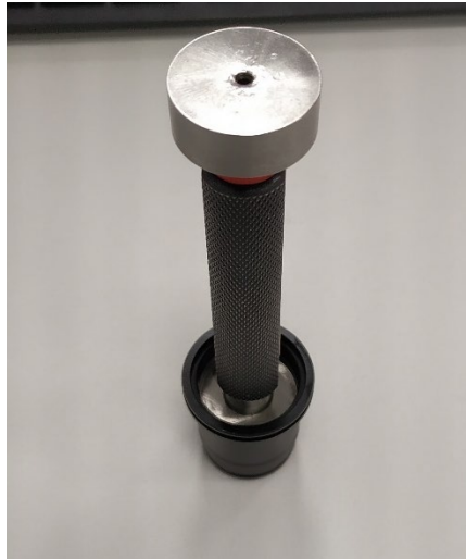
Figura 4.51 - Calibre para verificação da tolerância da cota interna do casquilho.
