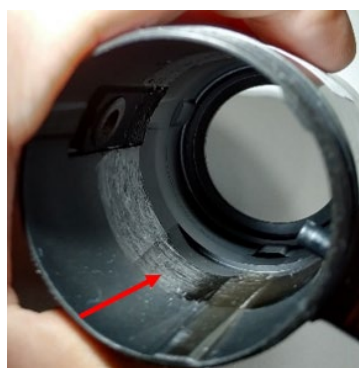
Figura 4.22 - Maior reflexão de luz em zona com Planatol.
