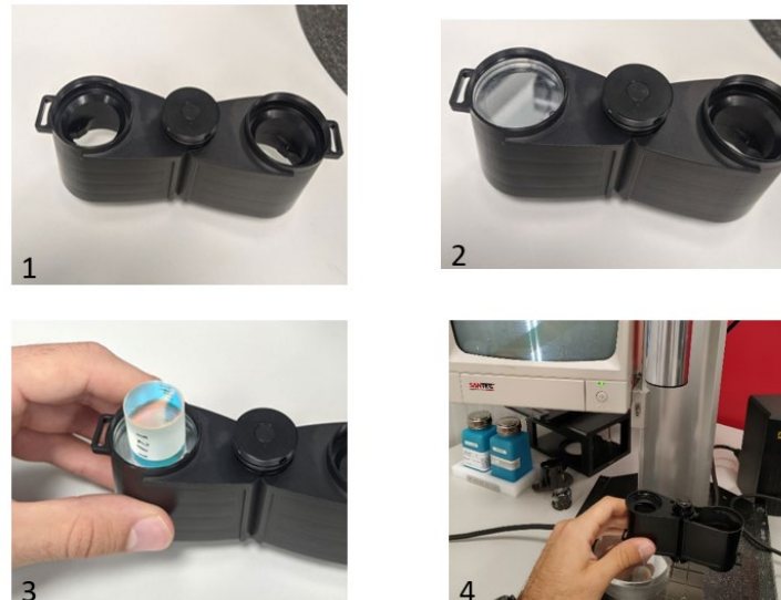
Figura 5.4 - Procedimento para verificação do eixo ótico do sistema de prismas montado no corpo do binóculo.
