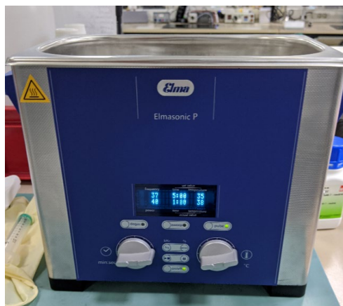
Figura 4.15 - Lavagem das molas na máquina de lavagem por ultrassons.
