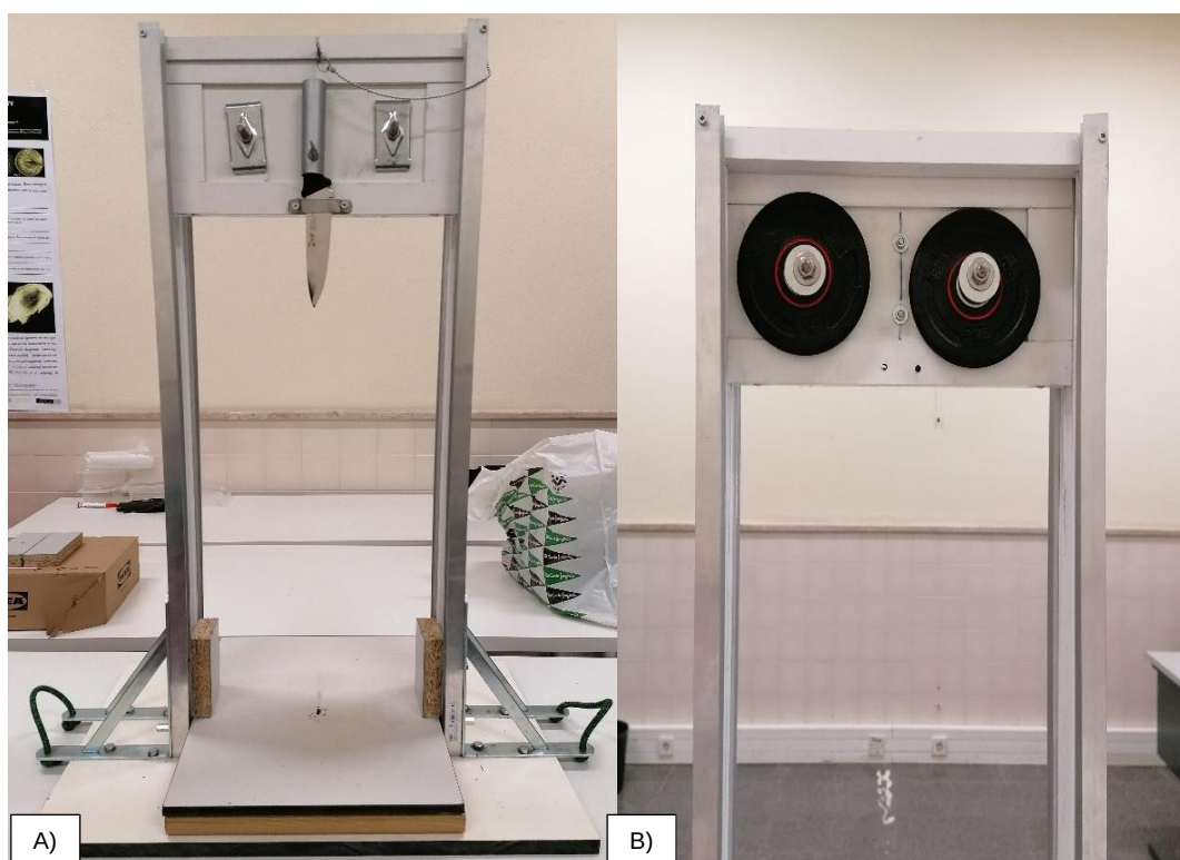
Figura 7 – Dispositivo fixo (“guilhotina”): A) vista anterior; B) vista posterior.
