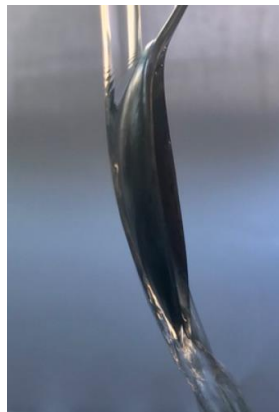
Figura 9 – Efeito de Coandă demonstrado numa colher.
