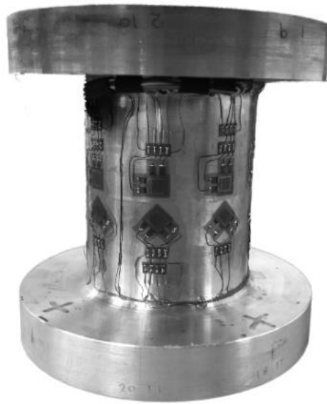
Figura 22 - Sensor de coluna equipado com células de carga [22].
