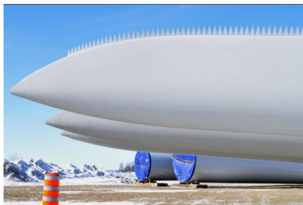
Figura 7- Pás de aerogeradores equipadas com blade serrations.
