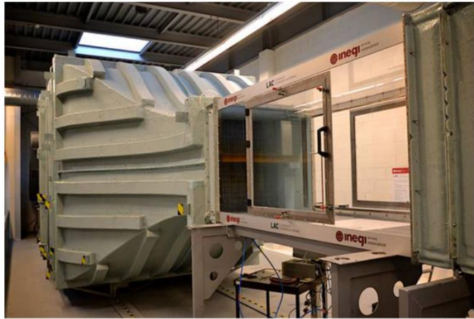
Figura 42 - Zona de contração e secção de testes do túnel do INEGI.
