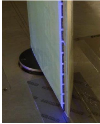
Figura 32 – Pá em modelo reduzido equipada com microtabs intercaladas [63].
