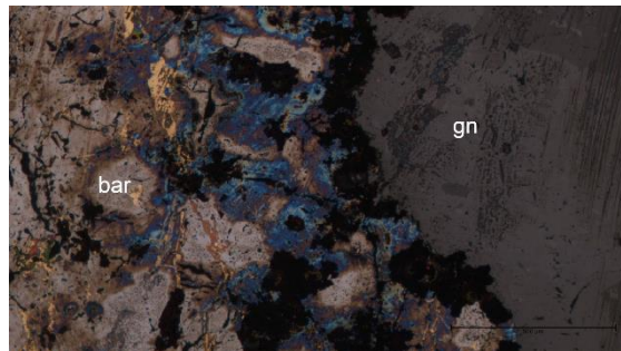
Figura 55 - Imagem obtida ao microscópio petrográfico de luz polarizada refletida, onde é observável o contacto entre a barite (bar) e galena (gn), em nicóis paralelos.
