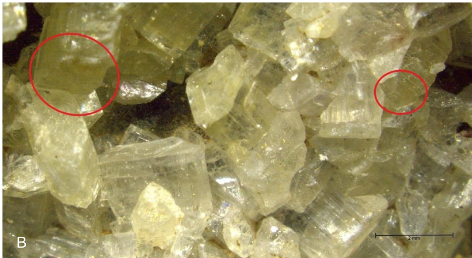
Figura 66 - Imagem obtida à lupa binocular de cristais de barite; cristais com configuração em losângica (círculo vermelho).
