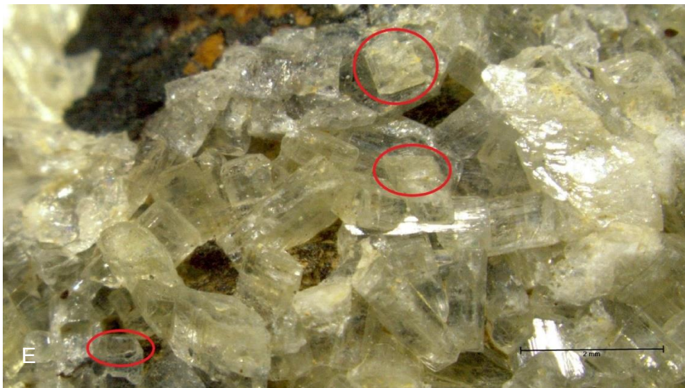
Figura 68 - Imagem obtida à lupa binocular de cristais de barite; cristais com configuração em losângica (círculo vermelho).
