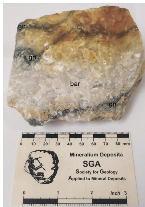
Figura 63 - Amostra ave_3 onde é observável a barite (bar), pirite (py) e galena (gn).
