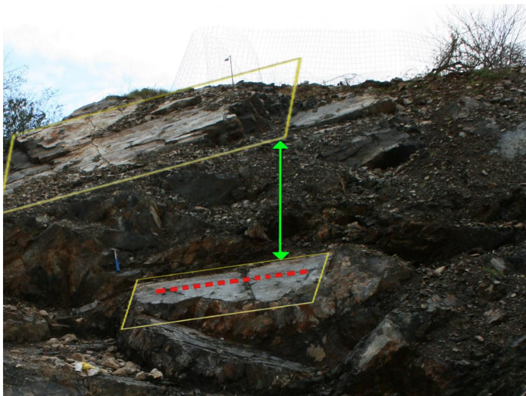
Figura 11 - Flancos da dobra (linhas amarelas), foliação do dunito (linha vermelha, tracejada) e espaçamento entre os planos de falha (seta verde); dimensão do martelo: 29cm.
