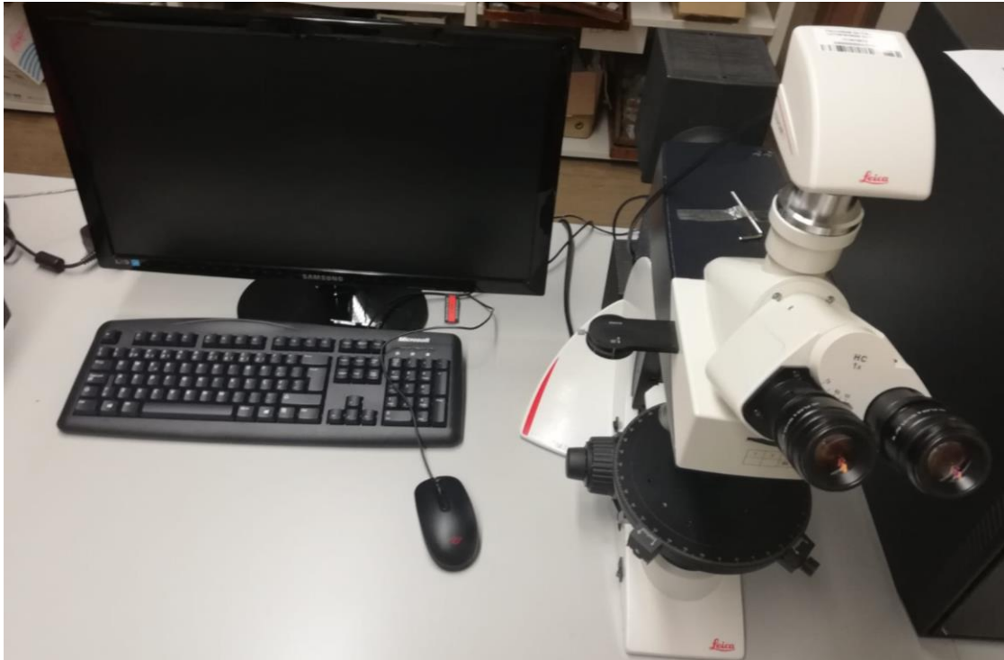
Figura 51 - Microscópio petrográfico de luz polarizada transmitida e refletida “Leica DM 2500 P” com a câmara fotográfica “Leica Flexacam C1” acoplada.
