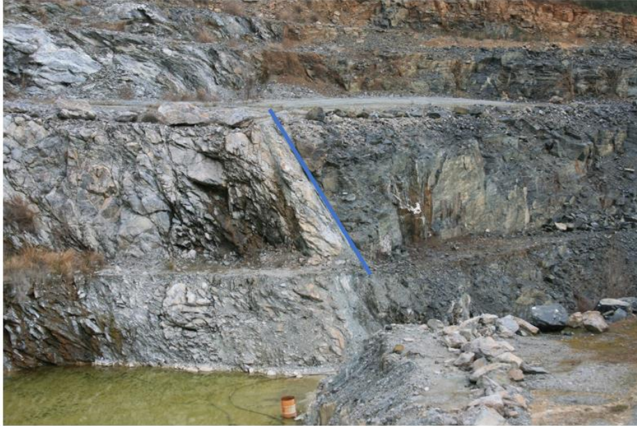
Figura 5 - Contacto tectónico de esteatitos (rocha clara, lado esquerdo) com anfibolitos (rocha escura, lado direito).
