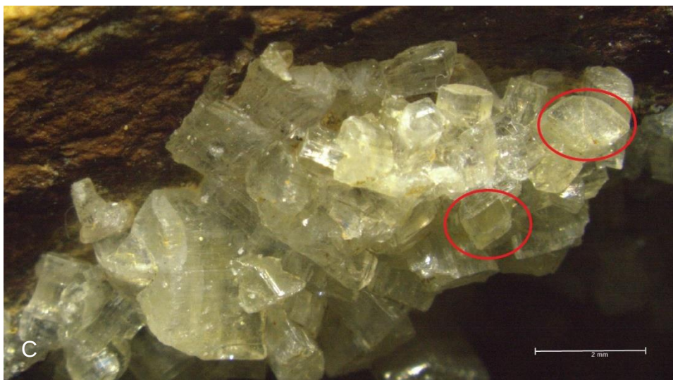
Figura 67 - Imagem obtida à lupa binocular de cristais de barite; cristais com configuração em losângica (círculo vermelho).
