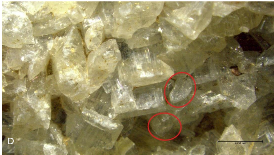
Figura 69 - Imagem obtida à lupa binocular de cristais de barite; cristais com configuração em losângica (círculo vermelho).
