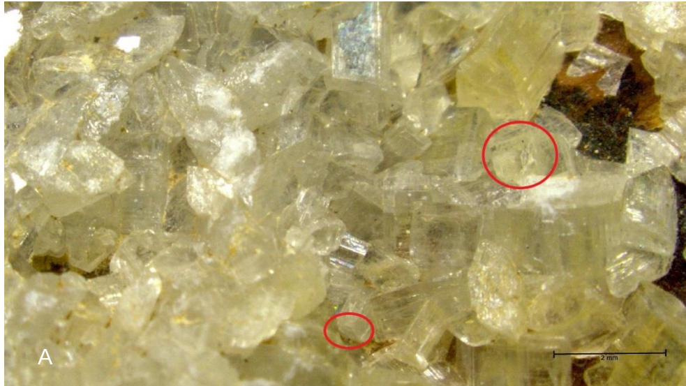
Figura 65 - Imagem obtida à lupa binocular de cristais de barite; cristais com configuração em losângica (círculo vermelho).
