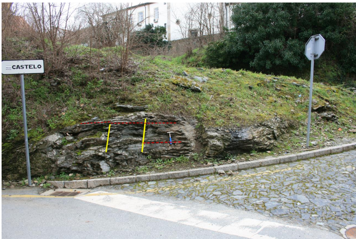
Figura 30 - Perspetiva geral do afloramento de rochas ultramáficas, a foliação das mesmas (a vermelho, tracejado) e fraturas (a amarelo); dimensão do martelo:29cm.
