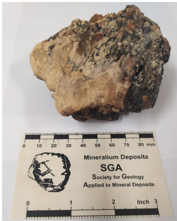
Figura 72 - amostra com óxidos de ferro e cristais de barite.
