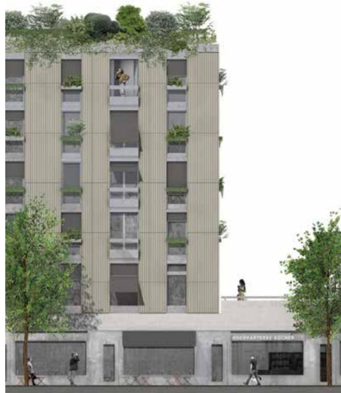
**Fig.81** Trecho do desenho de alçado voltado à rua Zollstrasse - destaque para os espaços comerciais no nível do rés-do-chão, pátio no 1º pavimento e jardim de cobertura
