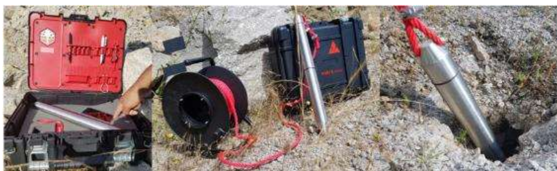
Figura 107 – Primeiro protótipo funcional utilizado em teste de campo para validar a operacionalidade do equipamento pelo método de Euler
