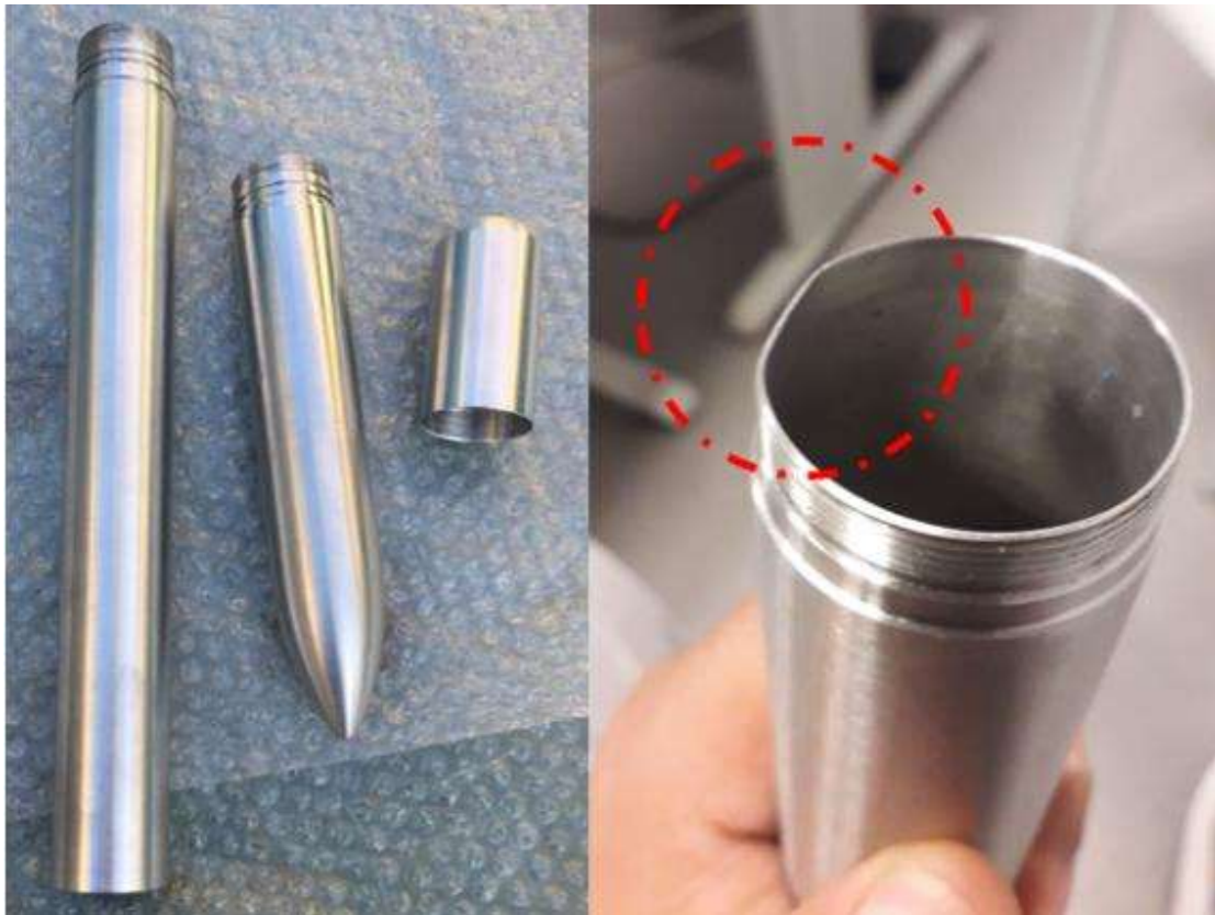
Figura 54 – Invólucro #6 em alumínio: a) desmontada; b) deformidade logo no primeiro impacto
