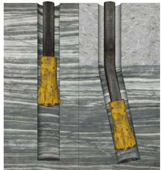
Figura 4 – Flexão da haste quando o bit passa de um meio mais brando a um de maior competência. Ilustração do autor adaptado de Hardrockdrills (2018)
