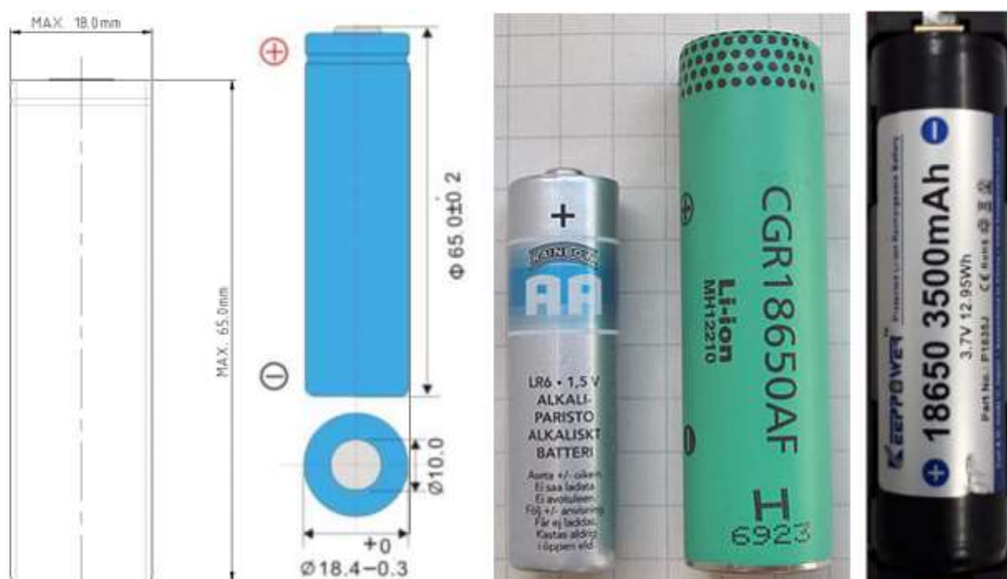
Figura 64 – a) e b) esboços com as dimensões de uma bateria de íões de lítio tamanho 18650 c) comparação com uma bateria alcalina AA para escala (Google), e d) bateria selecionada para o desviómetro (acervo do autor)
