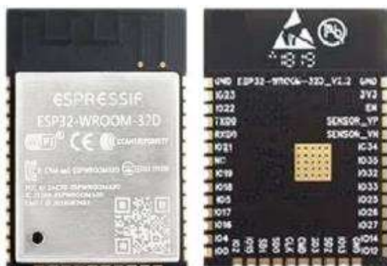
Figura 63 – Microcontrolador ESP32 WROOM 32U (Autoria do autor adaptado de Espressif Systems (2019))
