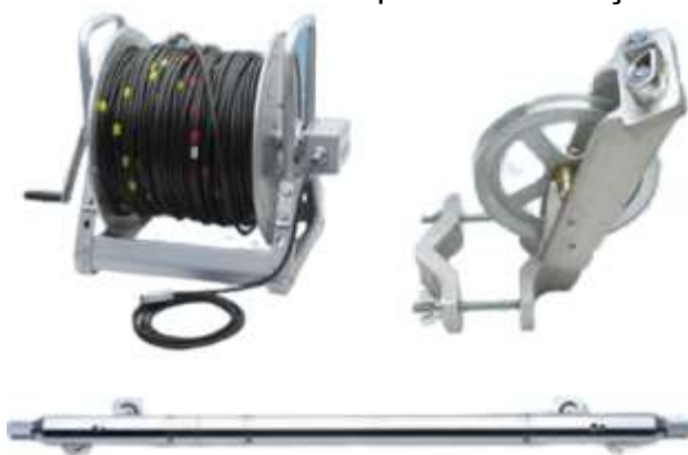
Figura 14 – Conjunto polia e carretel: mecanismos para o cabo de tração e transmissão de dados. Abaixo, sonda em aço inox (DGSI Slope Indicator, 2019)
