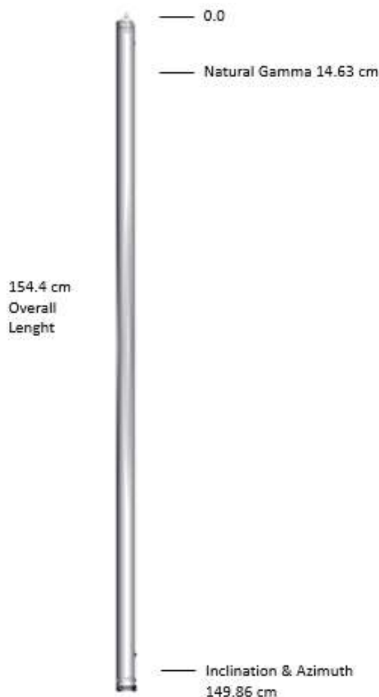
Figura 23 – Representação do modelo 9702 (fora de escala) (Century Geophysical LLC, 2019)
