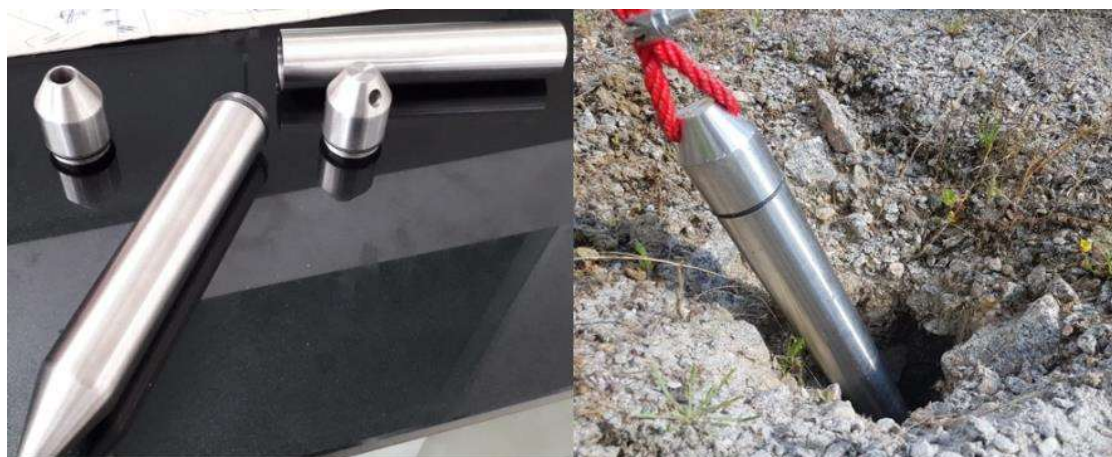
Figura 52 – Invólucro #4 com suas 2 peças para adaptação da sonda para uso com cabo ou corda
