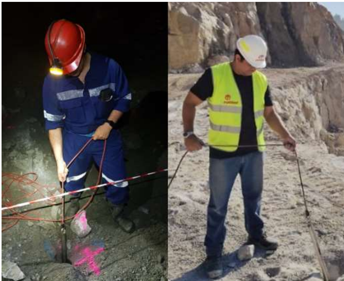
Figura 46 – Alguns dos registros dos vários testes positivos do desviômetro em furos descendentes, em mina subterrânea a pedreira a céu aberto (acervo do autor)
