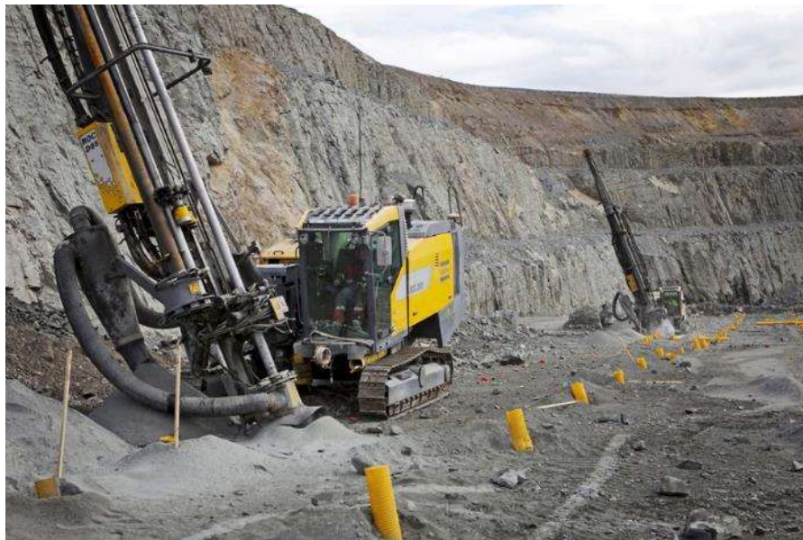
Figura 3 – Carro de perfuração SmartROC D65 perfurando uma linha de furos num ângulo de 20° (Mining & Construction, 2011)
