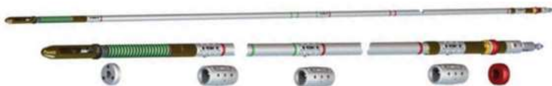
Figura 28 – Sonda do DeviFlexRapid (acima), e destaque dos 3 centralizados com rodas retráteis (abaixo) (RL & GV, 2011)
