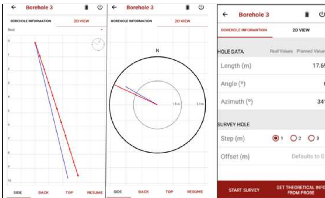
Figura 112 – Exemplo dos dados com duas rotações apresentados na aplicação do desviômetro
