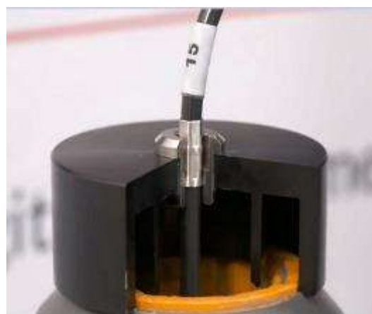
Figura 17 – Capa para o furo que em conjunto com a marcação no cabo permite que a altura das marcações seja uniforme (Soil Instruments, 2017)
