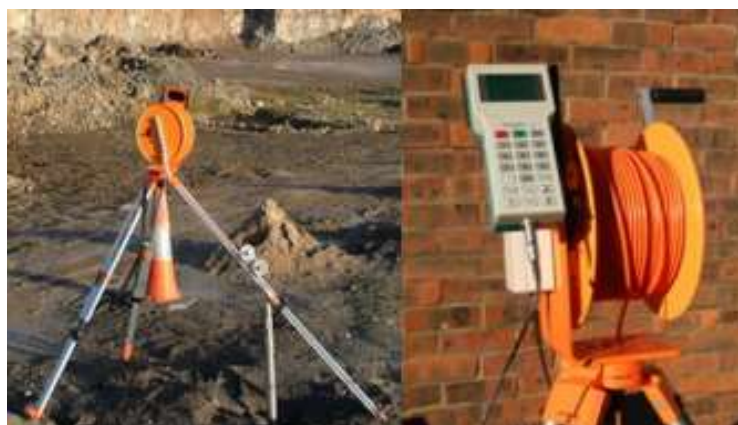
Figura 33 – Equipamento de medição da Pulsar©: Sistema tipo Guincho e a unidade de controle Datamat 5 (Ewer, 2018)
