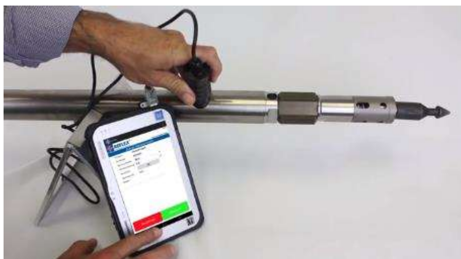
Figura 37 – Meio de transferência de dados entre a UC e a sonda por meio de cabo (Reflex Now, 2017)
