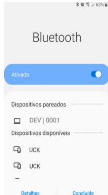
Figura 81 – Exemplo de tela da configuração Bluetooth com código da sonda pareada
