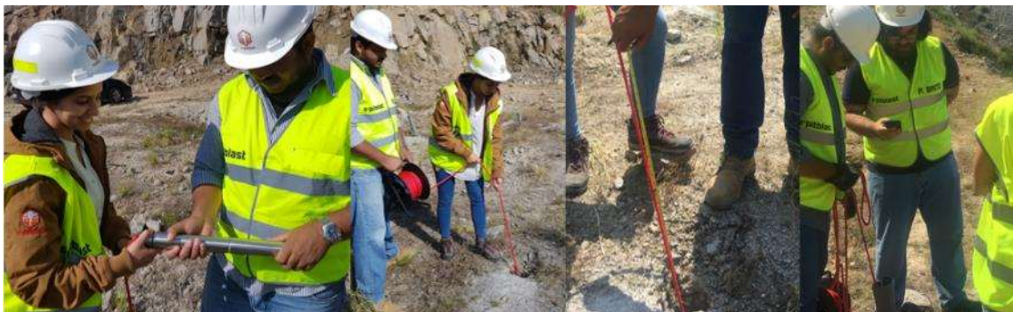
Figura 109 – Procedimento de campo: a) montagem da sonda; b) introdução da sonda no furo; c) medição do offset e; d) registro da medição
