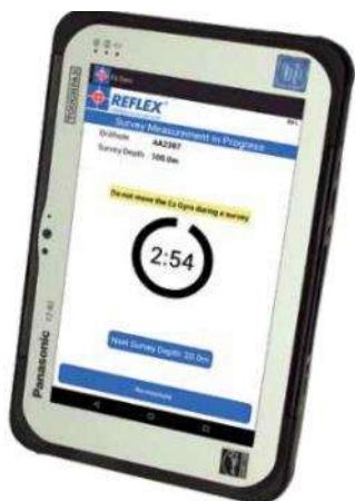
Figura 38 – Aplicativo de controle do Reflex Gyro™ (Reflex, 2018)
