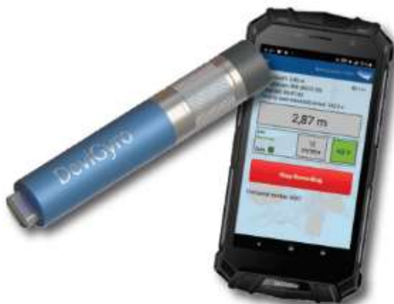
Figura 30 – Unidade de controle: Smartphone com aplicativo Android (Devico AS, 2019)
