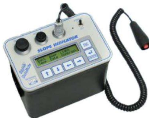
Figura 13 – Unidade de controle portátil robusta de alumínio de grandes dimensões (DGSI Slope Indicator, 2019)
