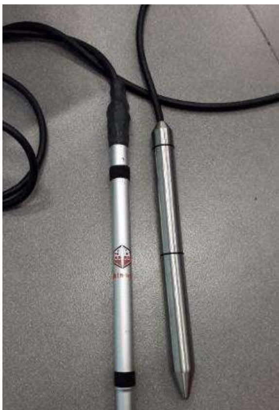
Figura 49 – Protótipos #2 (esq.) e #4 (dir.): únicas tentativas de transmissão de dados por cabo (acervo do autor)
