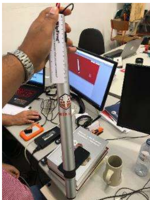
Figura 51 – Protótipo da sonda #1 com o invólucro #2: tubo de aspirador de pó adaptado com o primeiro sistema eletrónico (acervo do autor)
