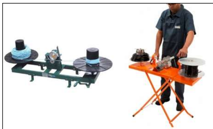
Figura 73 – Exemplos de máquinas para medir e enrolar cordas (Fonte: Google)
