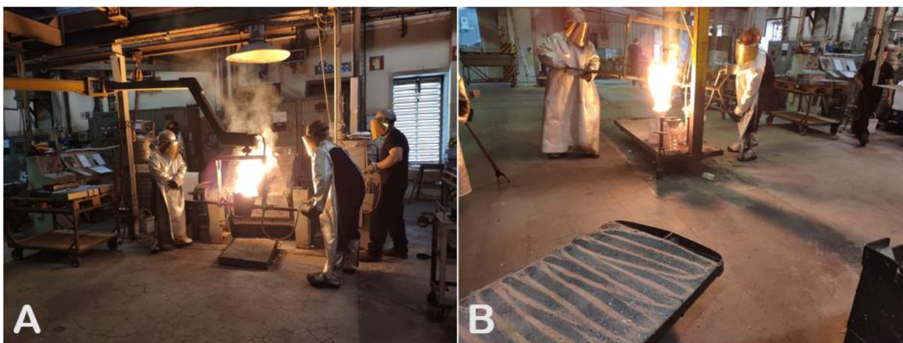
Figura 23. Etapa de vazamento do metal: A - do forno para a colher; B - da colher para as carapaças cerâmicas.
