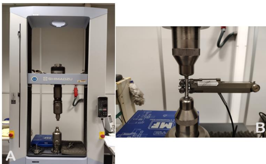
Figura 26. A - Máquina de ensaio de tração; B - Provete de ensaio de tração a que está acoplado o extensómetro.
