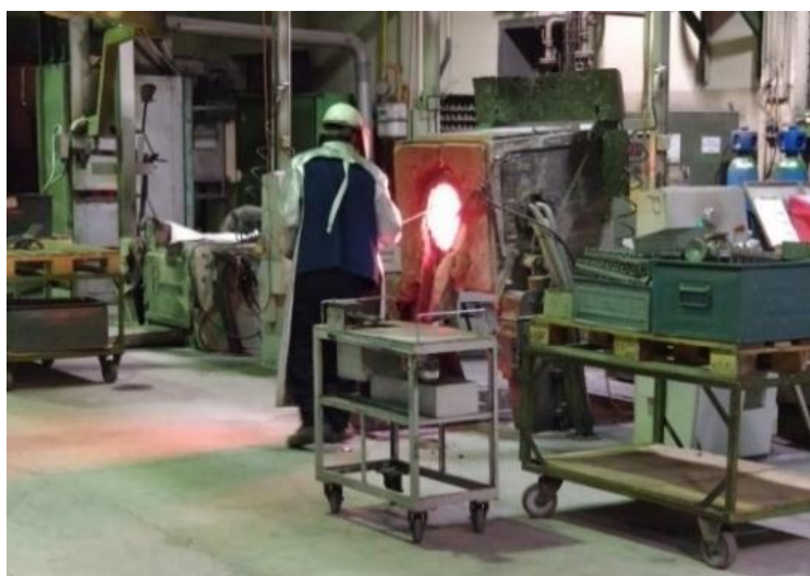
Figura 24. Operação de limpeza do forno após vazamento.
