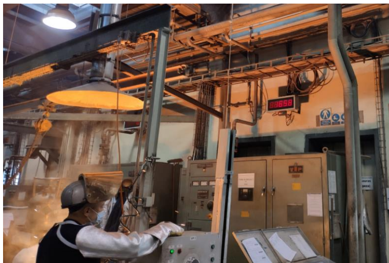
Figura 22. Controlo da temperatura do banho metálico.
