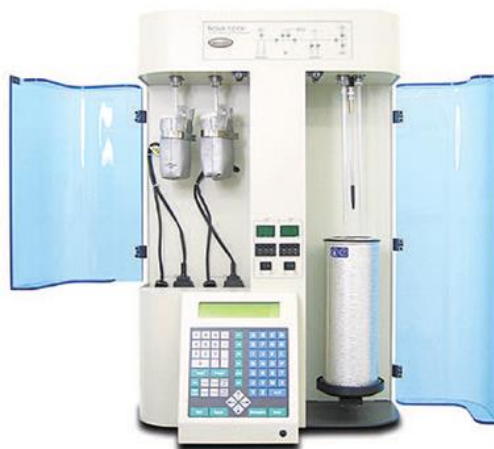
Figura A1 - Analisador de área superficial e tamanho de poros (Quantachrome Instruments NOVA 4200e).
