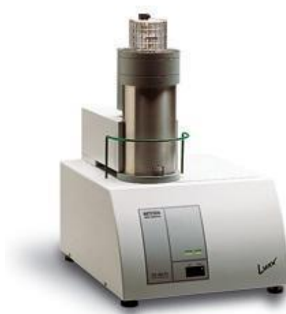
Figura A4 - Analisador termogravimétrico (Netzsch STA 409 PC).
