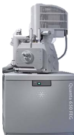
Figura A7 - Microscópio Quanta 650 FEG (FEI).
