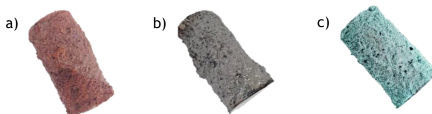
Figura 6 - EM antes (a) e depois do tratamento térmico (b) e EM com cobre antes do tratamento térmico (c).
