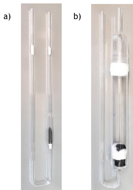
Figura A10 - Microreactor de leito fixo em forma de U com \varnothing = 0,7 cm (a) e \varnothing = 2,6 cm (b).
