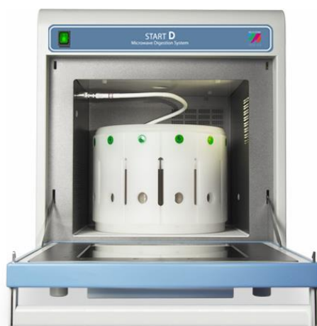
Figura A8 - Sistema de digestão por micro-ondas (Start D, Thermo Fisher Scientific).
