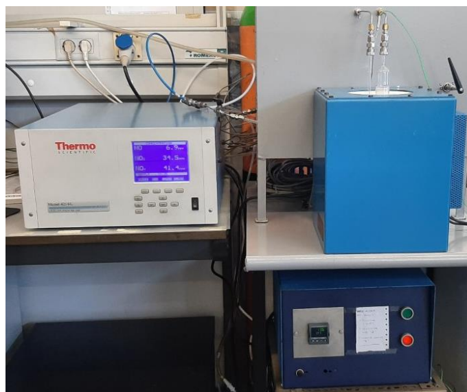
Figura A11 - Instalação experimental utilizada nos ensaios catalíticos.
