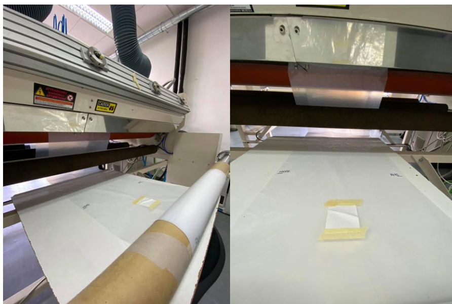
Figura 55 - Equipamento da tecnologia de plasma atmosférico e a amostra fixada com fita adesiva no rastilho de PET.
