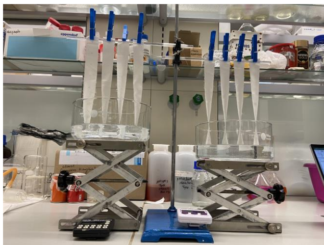
Figura 6 - Montagem experimental para o Wicking Test .
