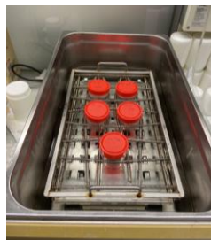
Figura 8 - Tingimento por impregnação por esgotamento.
