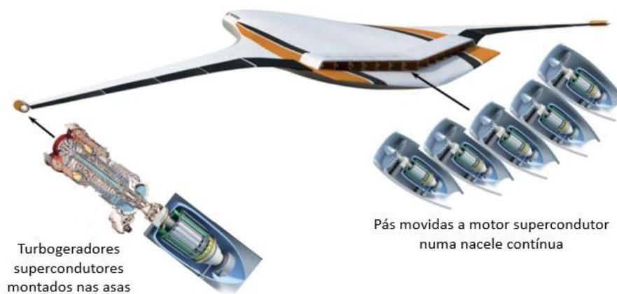
Figura 31-Aeronave N3-X com sistema de propulsão turbo-elétrico distribuído: Adaptado (Felder, Brown e Chu 2011)
