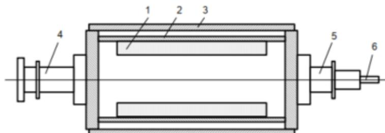
Figura 13-Motor síncrono supercondutor com rotor sem núcleo (Sivasubramaniam et al., 2006)
