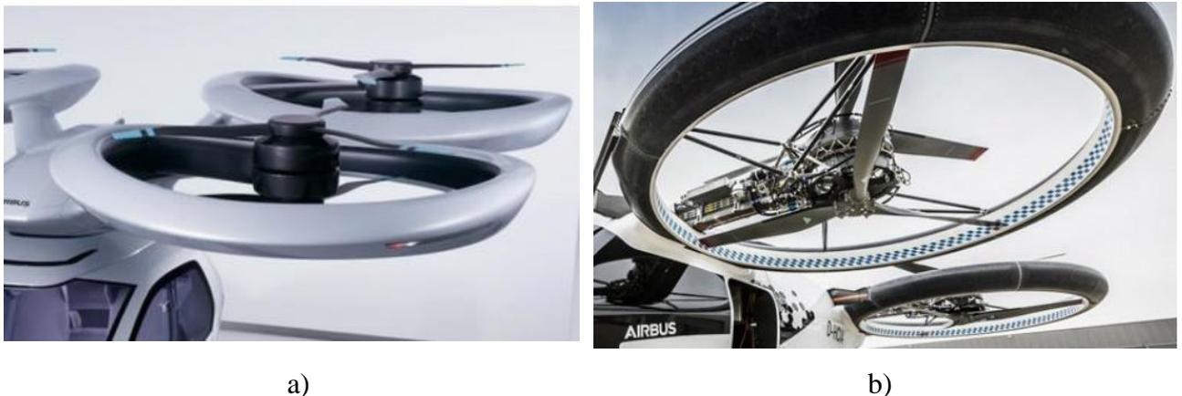
Figura 65-Exemplos de acoplamento entre motor-drone: a) Pop.Up; b) CityAirbus (Drška 2020; Italdesign 2018)
