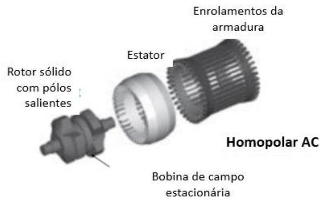
Figura 20-Configuração de gerador homopolar: Adaptado (Sivasubramaniam et al., 2006)
