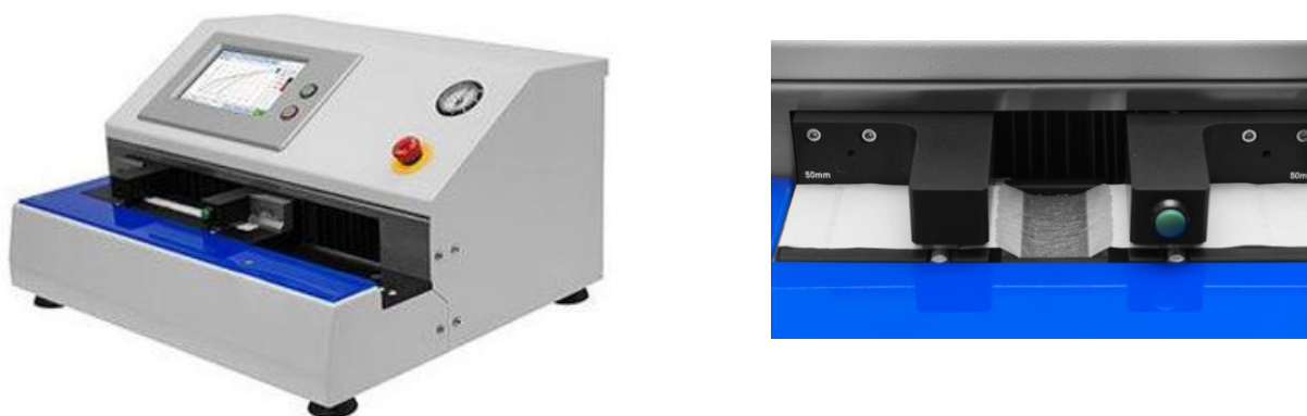
Figura 21-Dinamómetro Horizontal à esquerda e método de medição da resistência à tração a húmido à direita. [34]
