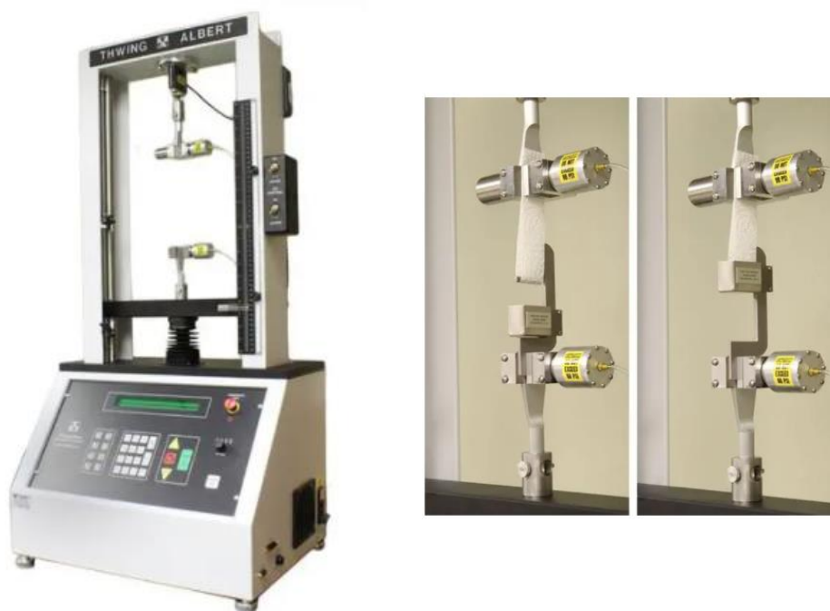
Figura 20 -Dinamómetro configurado para teste a seco à esquerda e o dispositivo de frinch utilizado para teste da resistência à tração a húmido à direita. [33]
