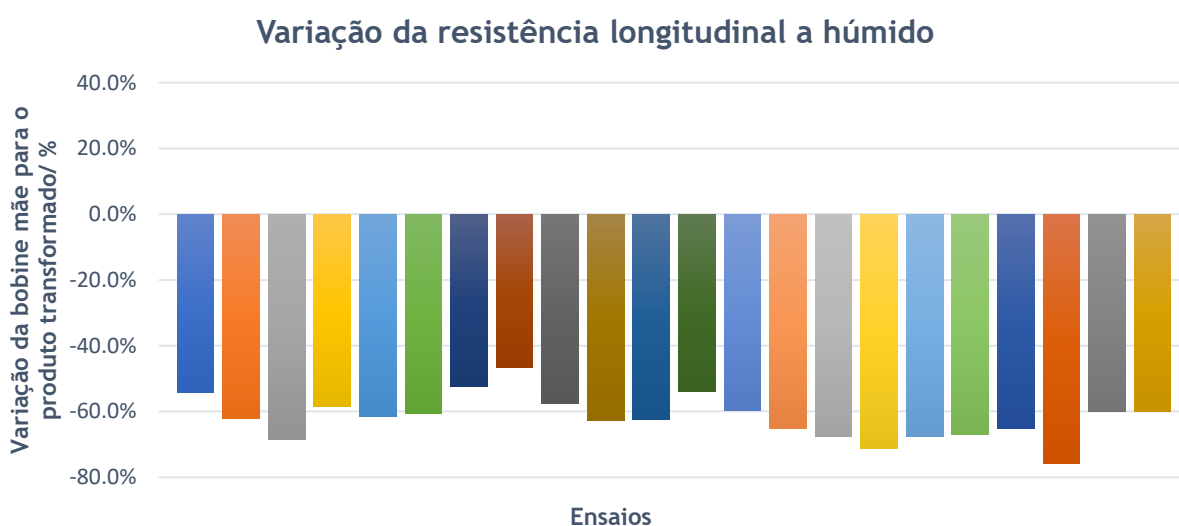
Figura B.7.8- Variação da resistência longitudinal a húmido da bobine mãe para o produto transformado para o RC 21 Stan.
