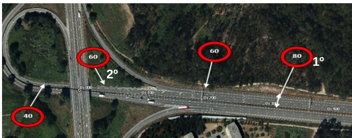
Figura 5.6-Localização Sinalização e colocação Viacount (Fonte:SIG ASCENDI)
