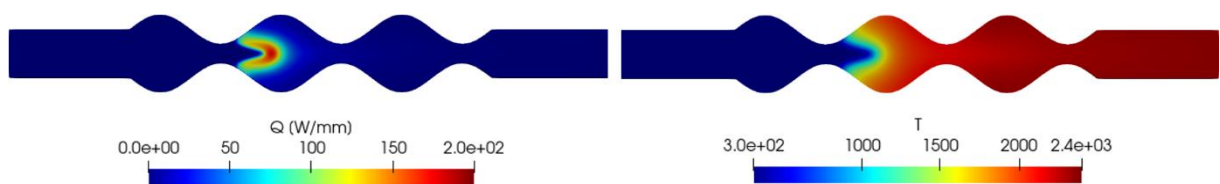
Figura 72 – Mapas de contorno do calor libertado (à esquerda) e da temperatura em K (à direita), relativos à simulação ADI_06 ( U=4 m/s e \phi=1,1 ) com duração de faísca de 0,5 ms.
