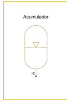
Figura 4.24-Bolco do modelo do acumulador.
