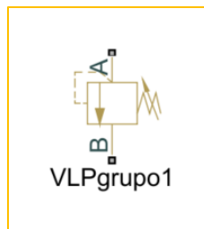
Figura 4.15-Bloco das válvulas limitadoras de pressão.
