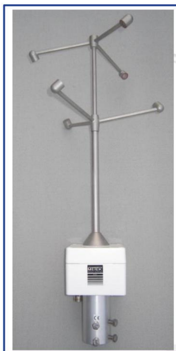
Figura 2.10 - Anemómetro sónico modelo uSonic-3 Scientific da METEK, in
