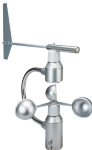
Figura 1.3 - Catavento montado por cima de um anemómetro de copos
