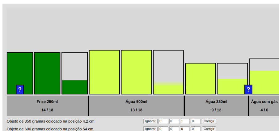
Figura 4.8: Representação do nível de stock existente numa prateleira, com indicação de dois objetos colocados fora do sítio.
