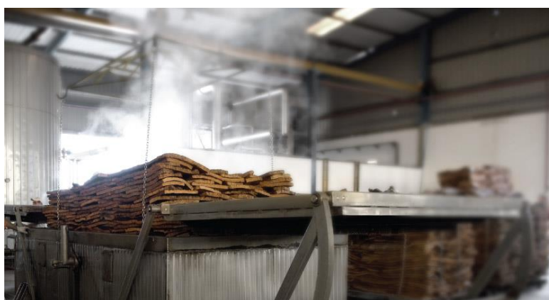
Figura 1.6. Processo de cozedura da cortiça em tanques de aço inoxidável (Relvas II S.A., 2021).
