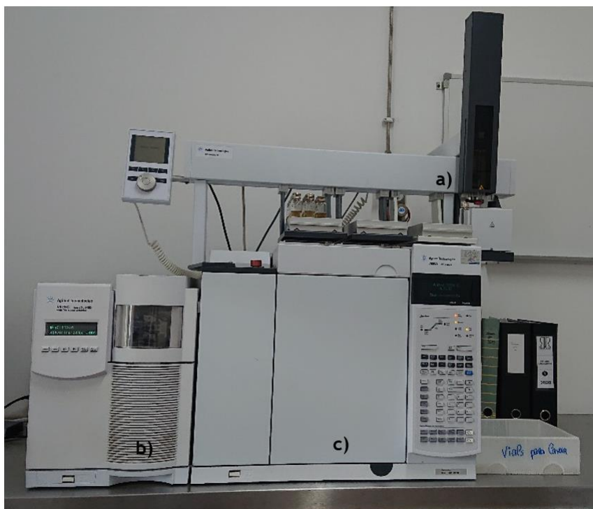
Figura A.1. Equipamento de análise por SPME-GC-MS: a) auto-sampler; b) MS; c) GC.
