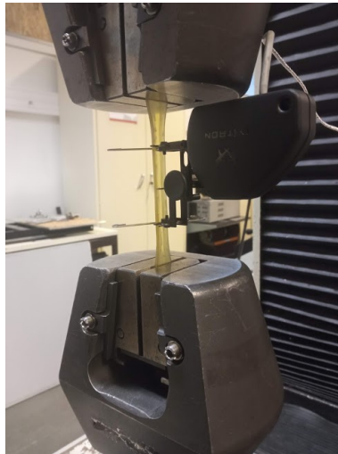
Figura 25: Extensómetro de caracol utilizado no ensaio mecânico de tração.
