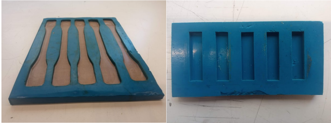
Figura 14: Moldes de silicone utilizados para a preparação dos provetes de tração (esquerda) e DMA (direita).
