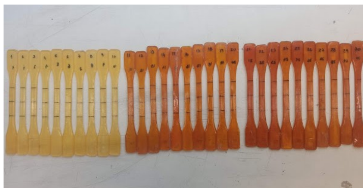
Figura 35: Provetes de tração testados: referência (esquerda), intermédio (centro) e final (direita).
