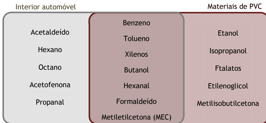
Figura 4: Compostos emitidos pelo interior automóvel, pelos materiais de PVC e por ambos.
