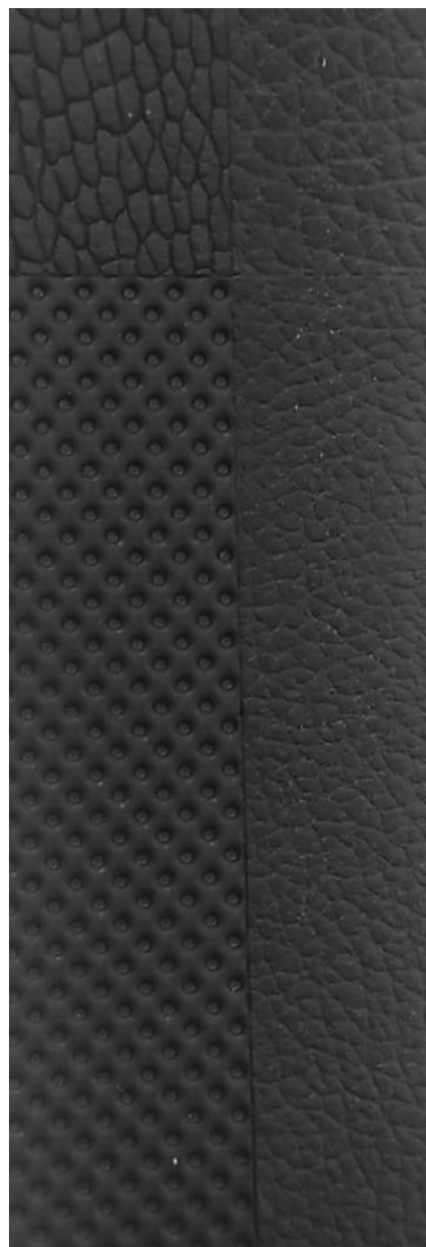
Figura N- 8: Amostra V15 moldada manchada com etanol.
