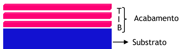
Figura 1: Esquema de aplicação das lacas no substrato.
