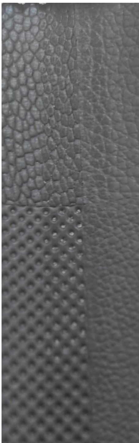
Figura F- 13: Amostra V6 - D1 moldada manchada com etanol.
