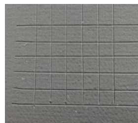
Figura 22: Amostra V5 com classificação A no teste de adesão.
