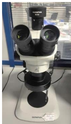
Figura 14: Lupa Olympus SZ61 equipada com Câmara SC50 .
