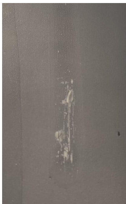
Figura E- 10: Amostra V4 manchada com etanol.
