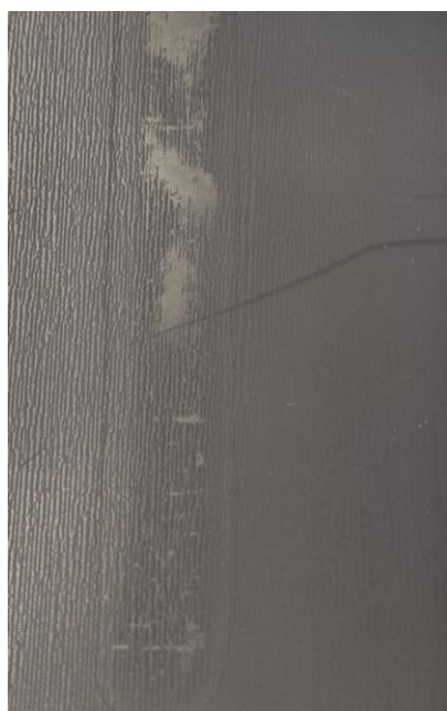
Figura E- 9: Amostra V4 - D1 manchada com etanol.
