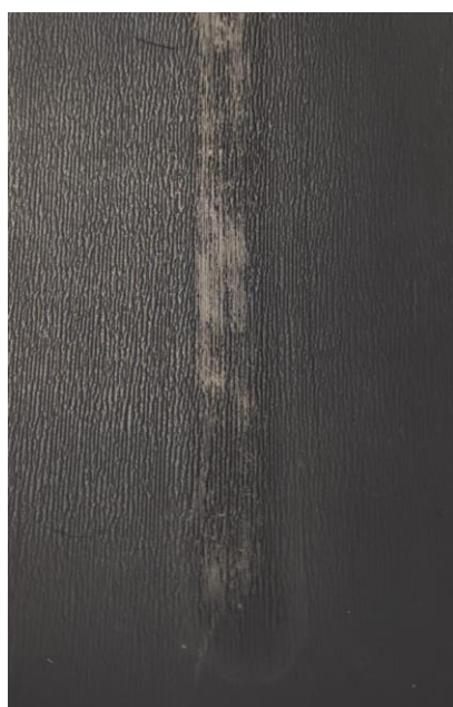
Figura E- 11: Amostra V5 - D1 manchada com etanol.
