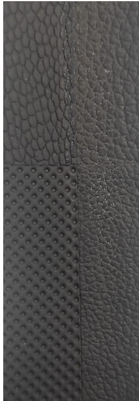
Figura F- 6: Amostra V2 moldada manchada com etanol.
