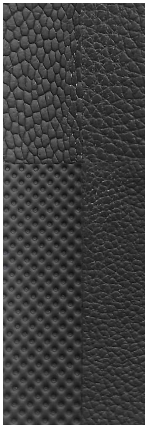
Figura J- 8: Amostra V10 moldada manchada com etanol.
