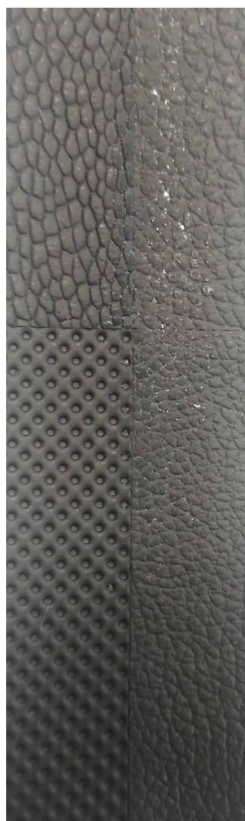
Figura N- 2: Amostra V12 moldada manchada com etanol.
