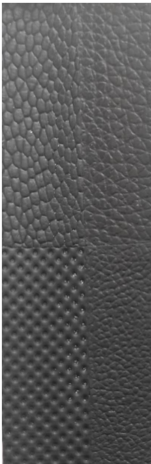
Figura F- 9: Amostra V4 - D1 moldada manchada com etanol.
