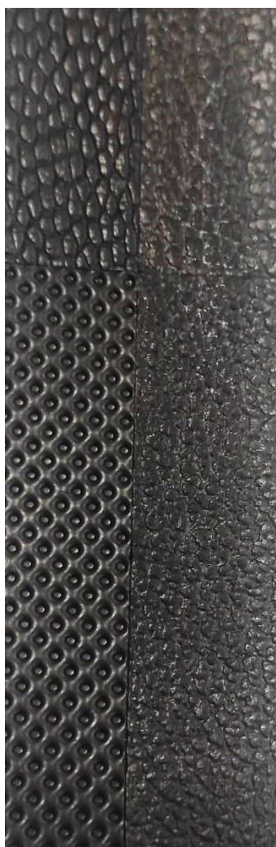
Figura N- 1: Amostra V12 - D1 moldada manchada com etanol.
