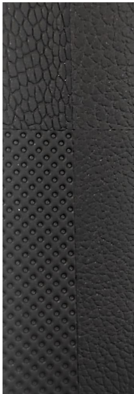
Figura N- 6: Amostra V14 moldada manchada com etanol.
