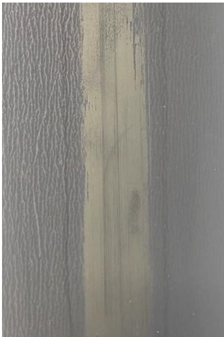
Figura M- 7: Amostra V15 - D1 manchada com etanol.
