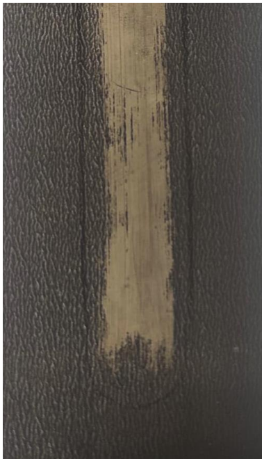
Figura M- 5: Amostra V14 - D1 manchada com etanol.
