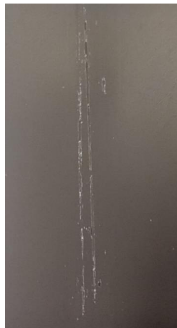
Figura E- 6: Amostra V2 manchada com etanol.
