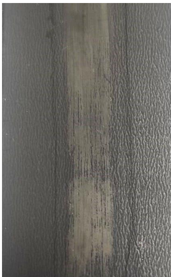
Figura M- 3: Amostra V13 - D1 manchada com etanol.
