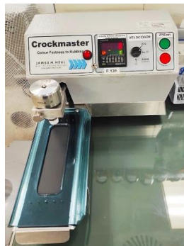
Figura 18: Equipamento de realização do teste do manchado de etanol.
