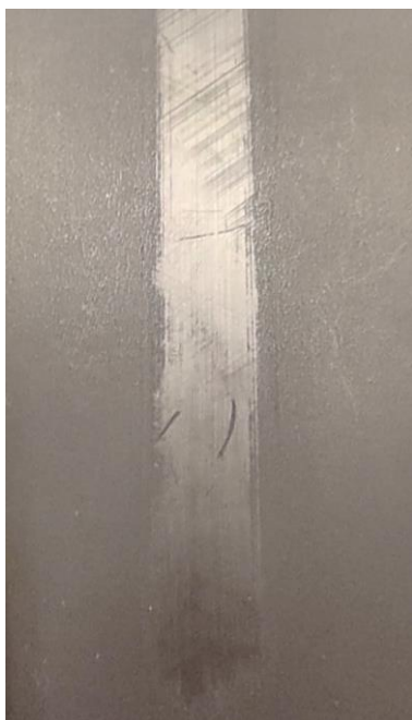
Figura E- 5: Amostra V2 - D1 manchada com etanol.
