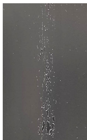
Figura I- 4: Amostra V8 manchada com etanol.
