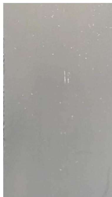
Figura I- 8: Amostra V10 manchada com etanol.
