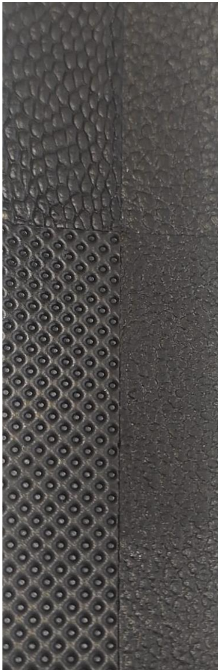
Figura F- 5: Amostra V2 - D1 moldada manchada com etanol.
