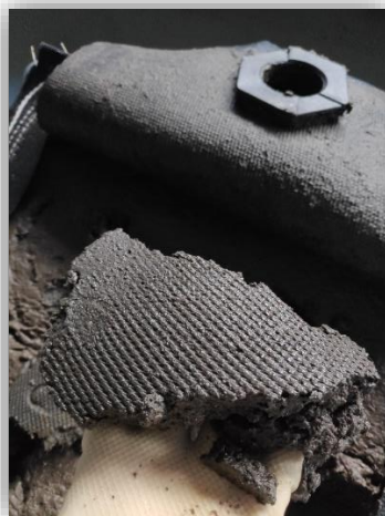
Figura 74 – Amostra de lamas desidratadas retirada do interior do Geobag® após 3 dias de consolidação no interior da estrutura.
