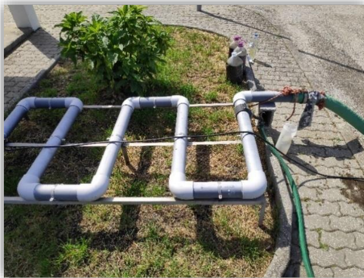
Figura 45 – Circuito da tubagem das lamas antes do encaminhamento para a unidade Geotube®.
