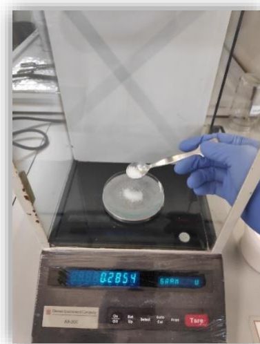
Figura 54 – Pesagem de um floculante em pó numa balança analítica.
