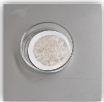
Figura 67 – Papel de filtro utilizado nos ensaios de determinação dos SST no centrifugado da ETAR em Fimalicão.
