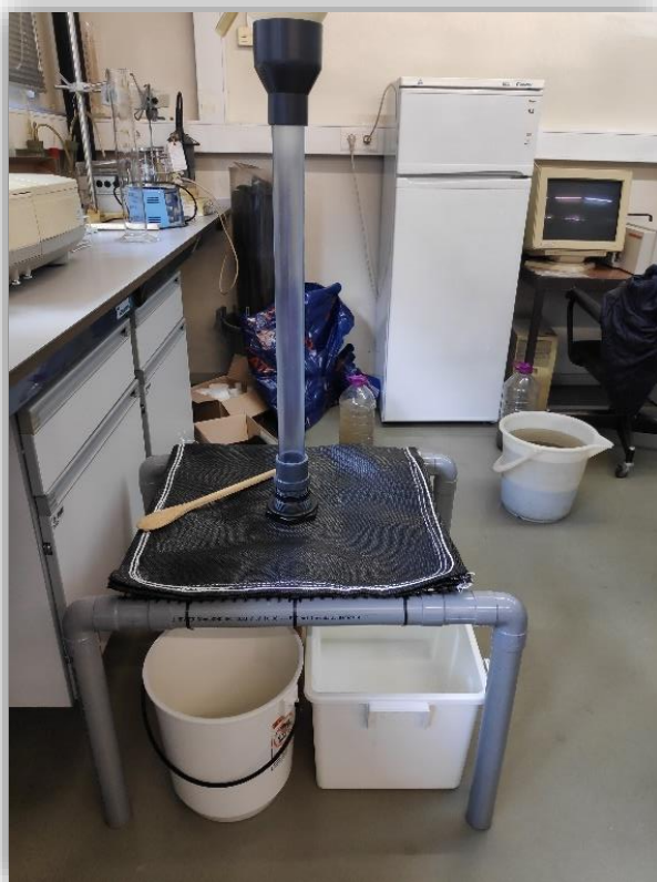
Figura 64 – Instalação do GDT test.
