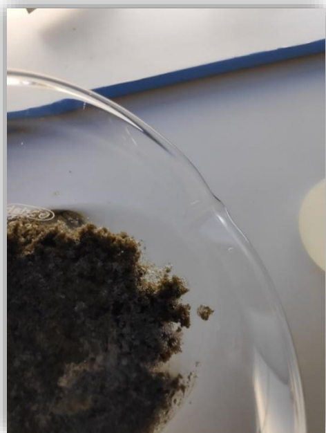
Figura 71 – Exemplo de uma floculação adequada com separação evidente dos flocos formados e sobrenadante.
