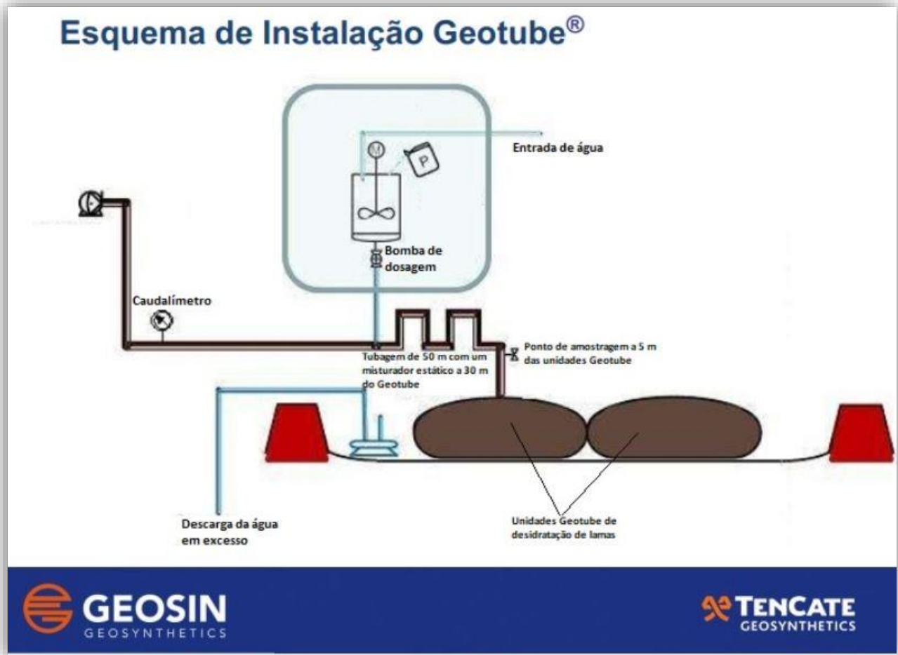
Figura 31 – Instalação de uma unidade Geotube® (Adaptado de Tencate Geotube®, 2021).
