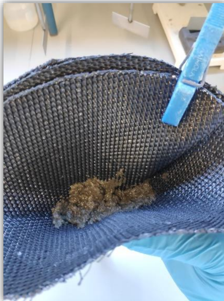
Figura 63 – Lamas no interior da membrana Geotube® antes de ser aplicada pressão.
