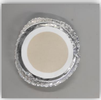
Figura 68 – Papel de filtro utilizado nos ensaios de determinação dos SST no filtrado da unidade Geotube® da ETAR na Figueira da Foz.
