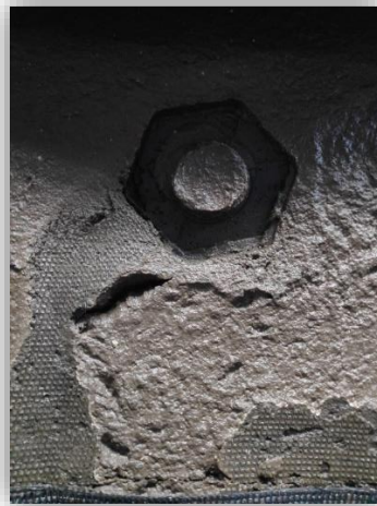
Figura 73 – Lamas desidratadas após 3 dias de consolidação no Geobag®.
