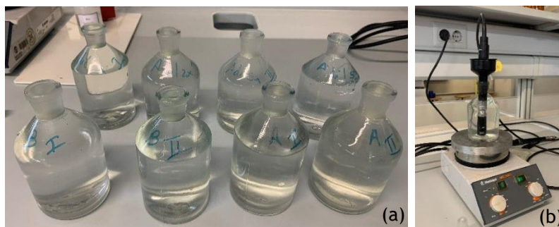
Figura 11 - Imagens a) dos frascos preparados e rotulados e b) da instalação para a leitura de oxigênio dissolvido.
