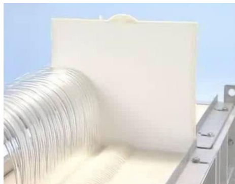
Figura 4 - Módulo de membranas de placa plana 28 .
