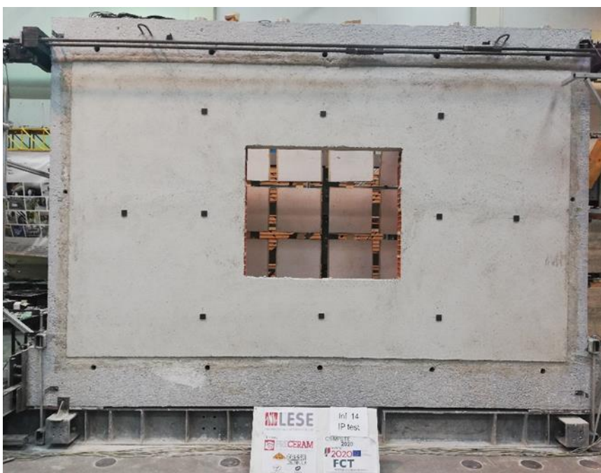
Fig. 36 - Parede com abertura in situ
