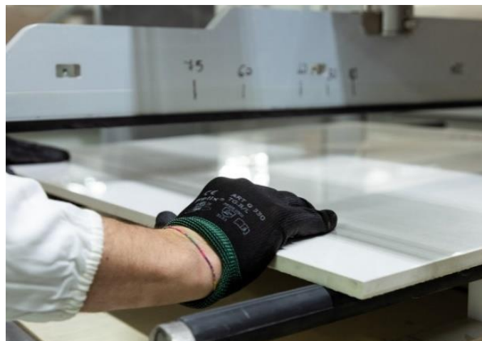
Figura 7 – Serragem das peças, para as dimensões pretendidas (Epd [et al.], 2018e).
