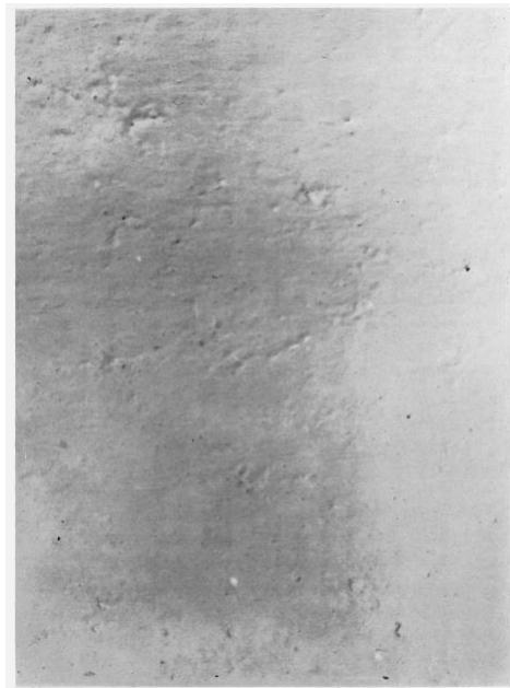
Figura 3.12 – Aparência da superfície da amostra 8 depois de pintada com pincel com quatro demãos de tinta (ampliada) [25].
