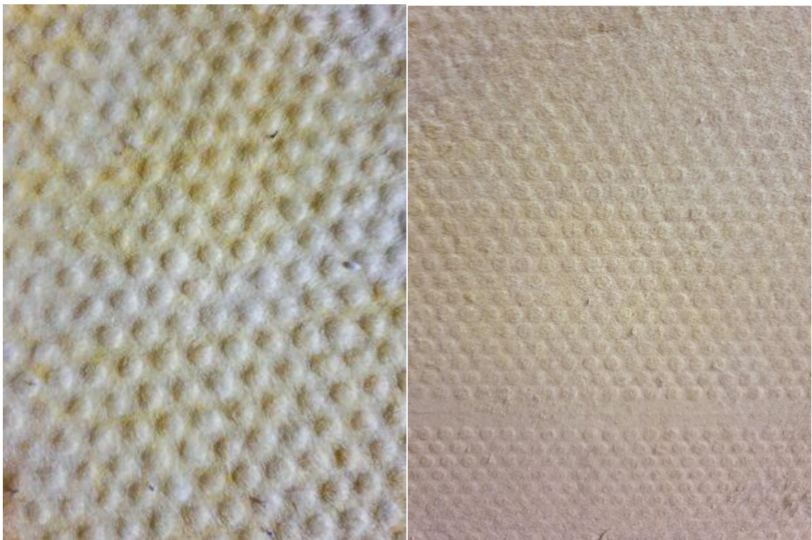
Figura 4.11 – Pormenor de um painel da amostra de lã mineral ISOVER sem pintura (esq.) e com pintura (dir.) [fotos do autor].
