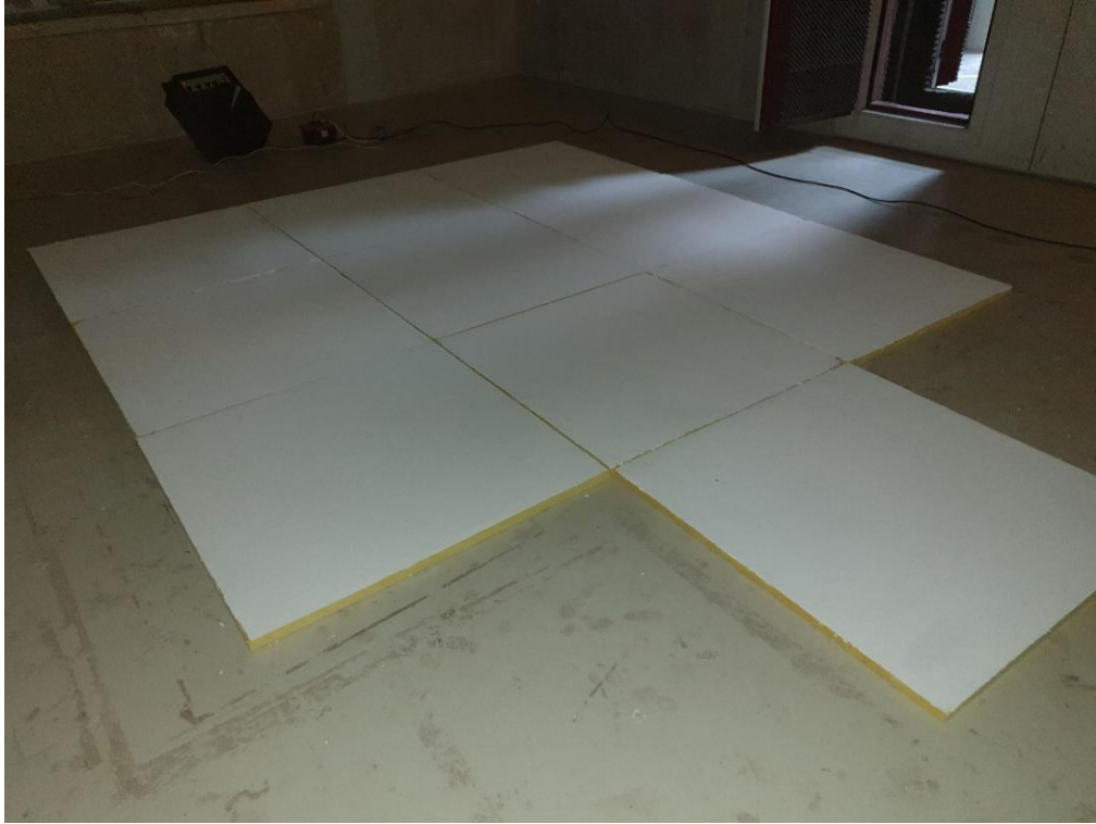
Figura 4.3 – Disposição das placas de Sonacoustic@ ALM no piso da câmara reverberante para a realização do ensaio sem pintura [foto do autor].
