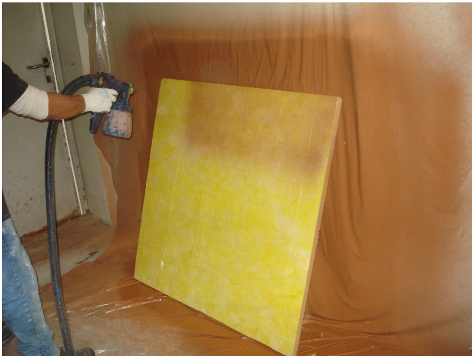
Figura 4.9 – Realização do processo de pintura à spray da amostra de lã mineral ISOVER [foto do autor].
