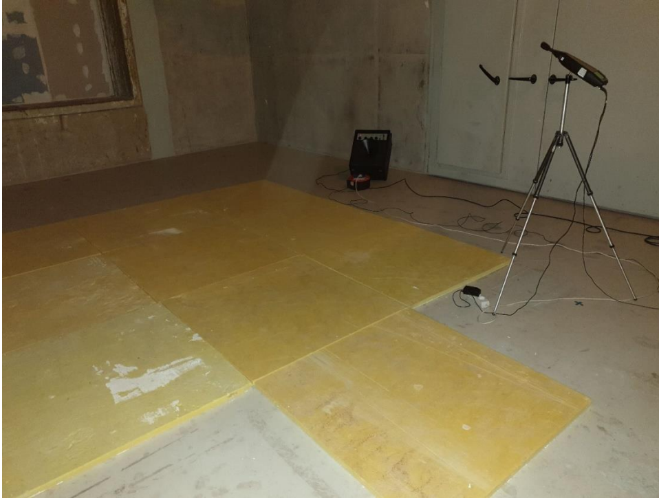
Figura 4.8 – Disposição das placas de Sonacoustic® ALM expostas (viradas do avesso) no piso da câmara reverberante para a realização do ensaio da lã mineral ISOVER sem pintura [foto do autor].
