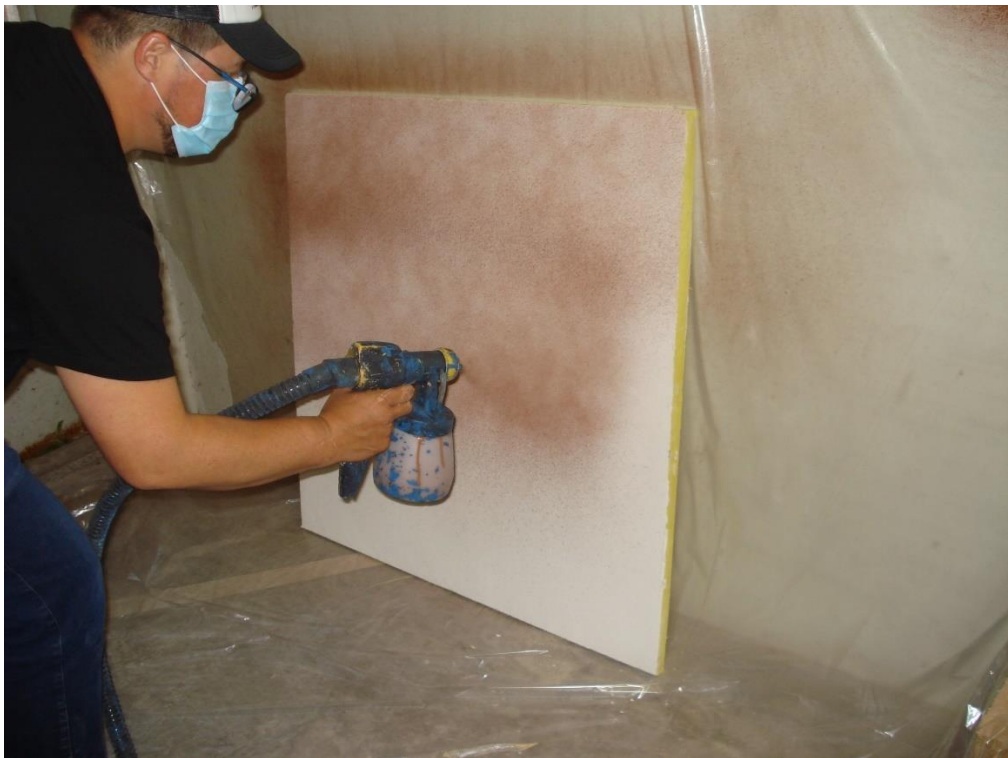
Figura 4.4 – Realização do processo de pintura à spray da amostra de Sonacoustic@ ALM [foto do autor].
