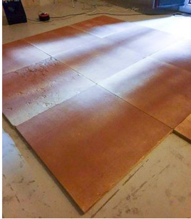
Figura 4.10 – Disposição das placas de Sonacoustic® ALM expostas (viradas do avesso) no piso da câmara reverberante para a realização do ensaio da lã mineral ISOVER após pintura [foto do autor].
