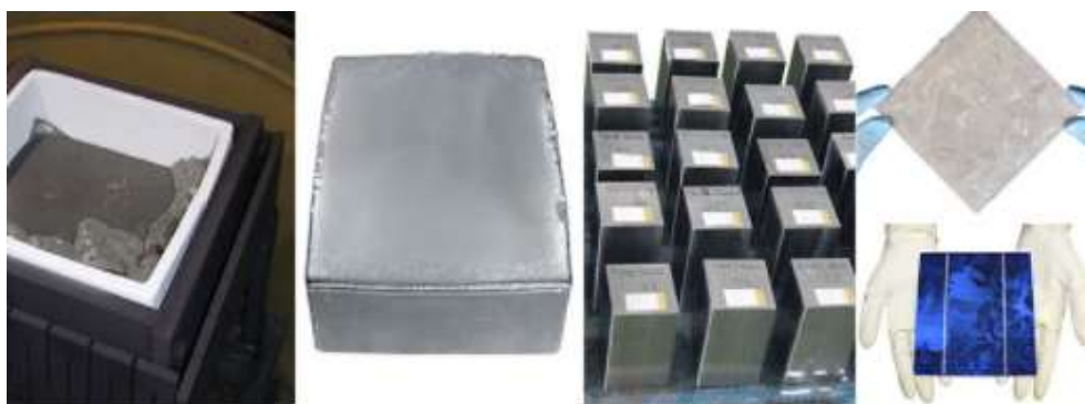
Figura 2.2 – Célula policristalina: processo de fabrico, silício fundido em blocos e o aspeto da célula [9]
