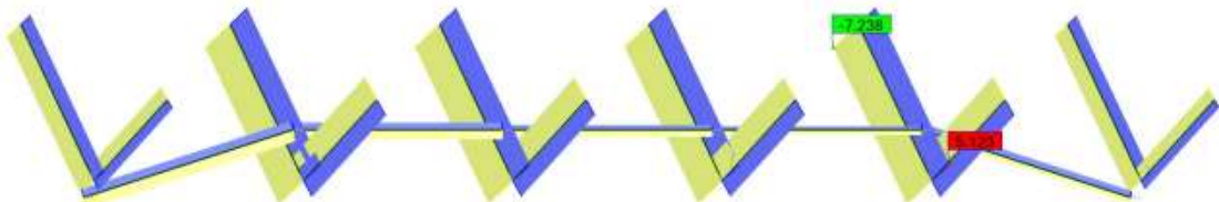
Tilt 20° - Esforço Axial máximo local nas escoras
