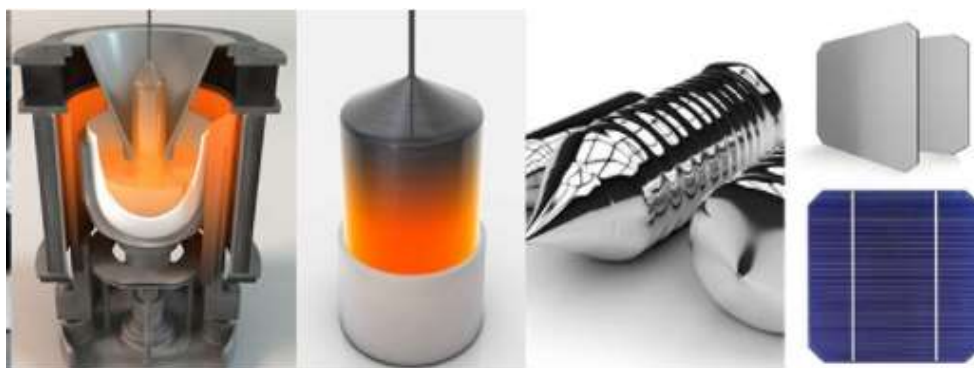
Figura 2.1 – Célula monocristalina: forno de fabrico, lingote de silício, lâminas de silício e formato [9]
