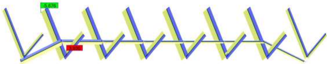
Tilt 25° - Esforço Axial máximo local nas escoras
