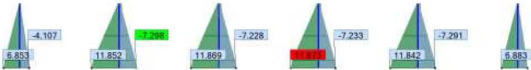
Tilt 20° - Momento fletor em torno do eixo y máximo local nos pilares
