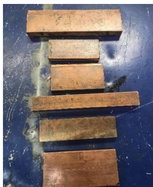
Figura 21 - Eléktodos utilizados para soldar arame
