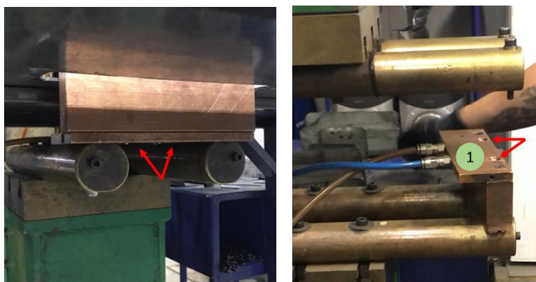
Figura 32 - Mecanismo para fixar ou retirar os elétrodos da estrutura inferior da máquina
