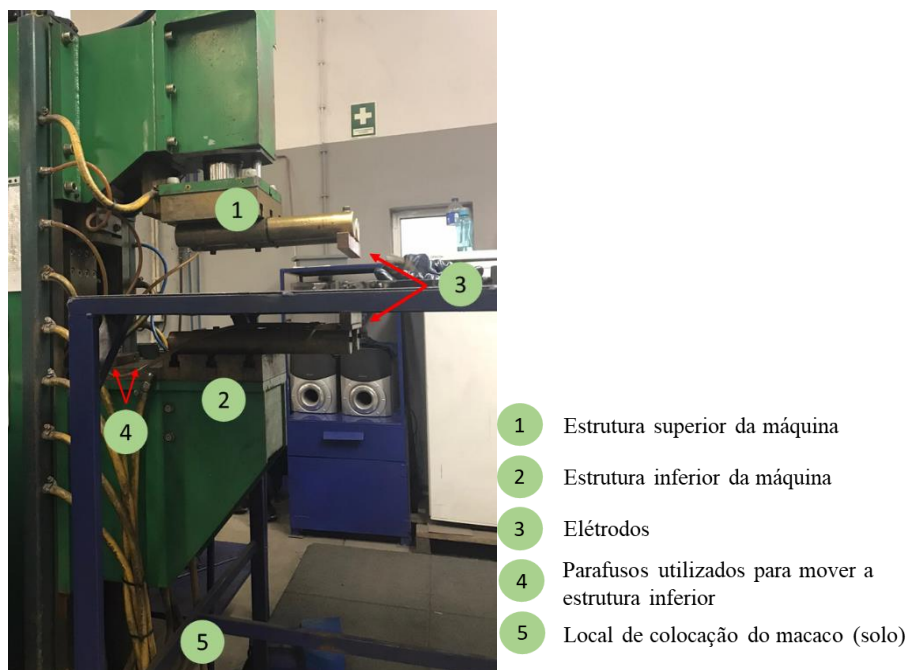
Figura 20 - Elementos essenciais utilizados na mudança de série da máquina
