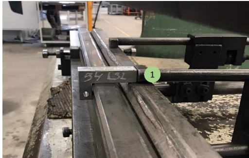
Figura 35 - Demonstração da utilização dos batentes criados
