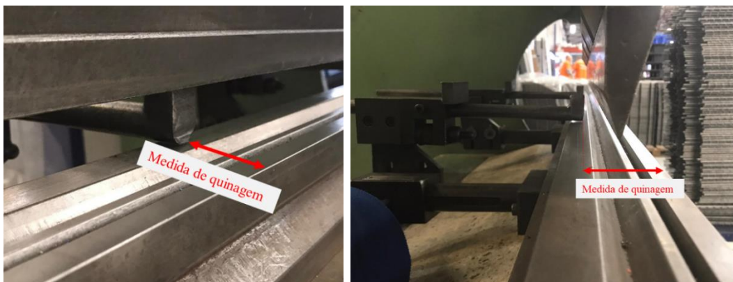
Figura 22 - Representação da medida de referência para a quinagem
