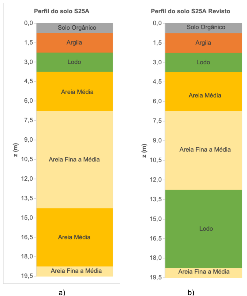
Figura 4.17 - S25A: a) Perfil do solo; b) Perfil do solo revisto
