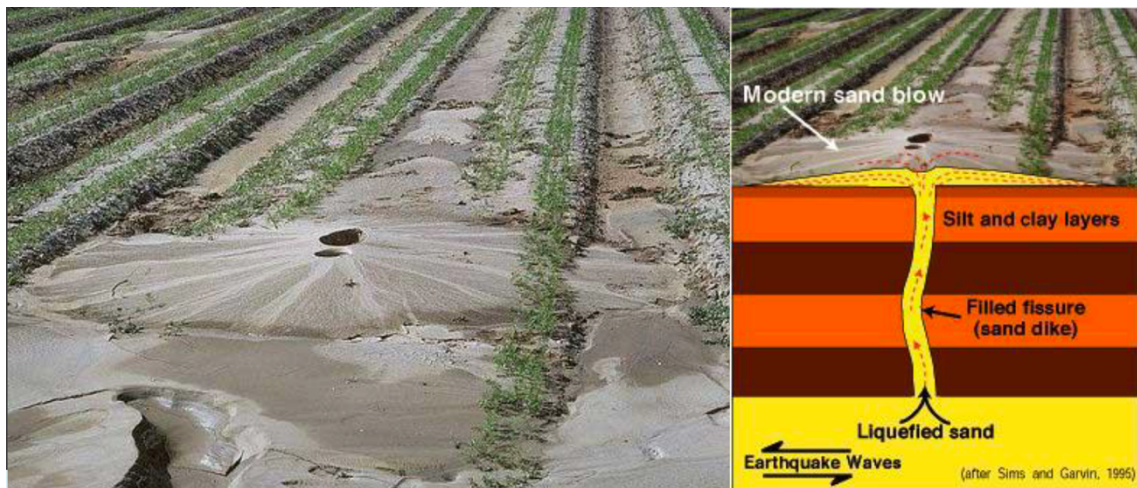
Figura 2.2 - Esquema Típico da Liquefação Cíclica (Viana da Fonseca et al., 2016)
