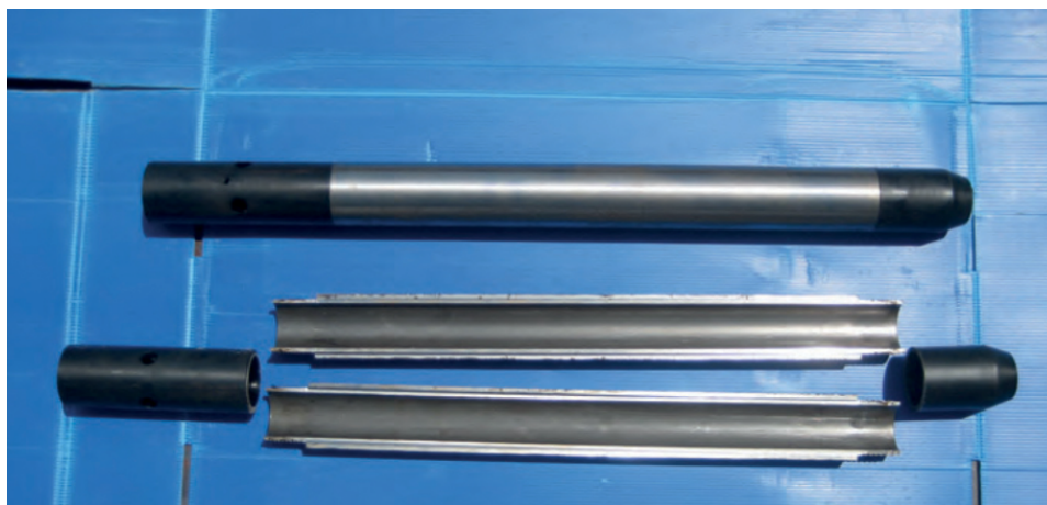
Figura 2.11 - Amostrador normalizado de Terzaghi (Matos Fernandes, 2015)
