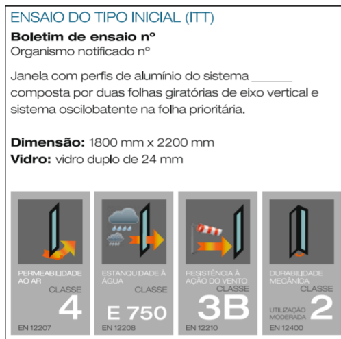
Figura 50 - Resultado de ensaio tipo inicial (ITT) (Extrusal, Catálogo Sistema de Batente, 2016)
