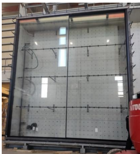
Figura 1 - Ensaio de permeabilidade à água
