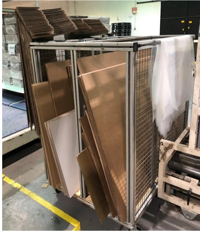
Figura 39 - Carrinho de proteções para paletes
