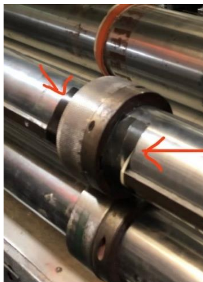
Figura 22 - Preparação com fixação de mangais com fita auto-adesiva
