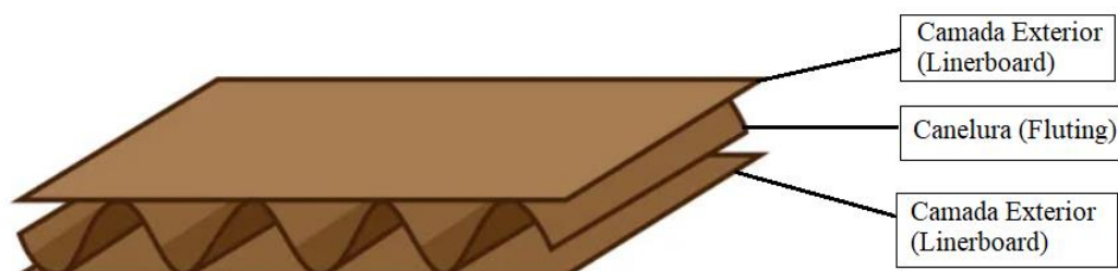
Figura 4 - Camadas que constituem uma placa de cartão com uma canelura
