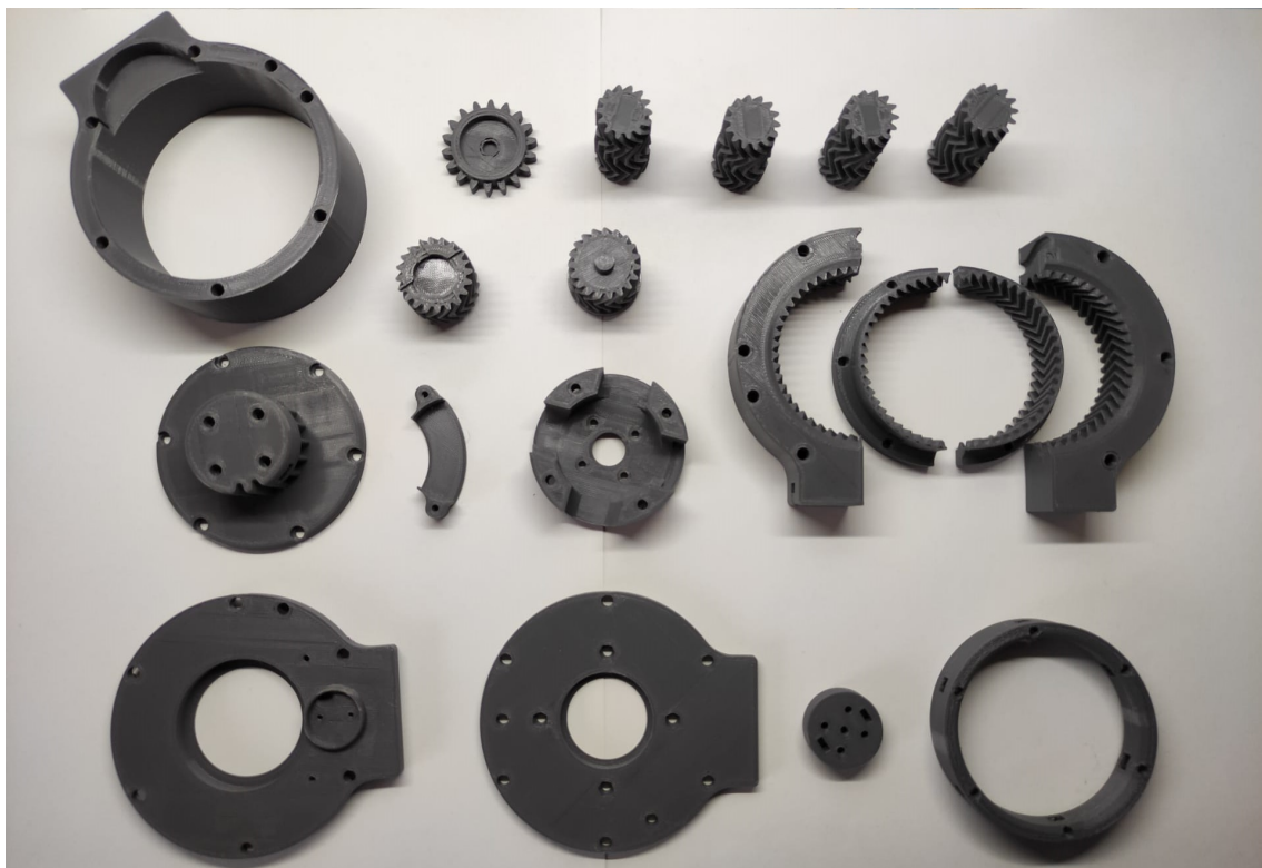
Figura A.2: Componentes impressos da Articulação Modular para Braços Robóticos.
