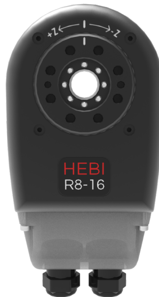
Figura 2.5: Articulação modular Hebi Robotics R8-16 [4].
