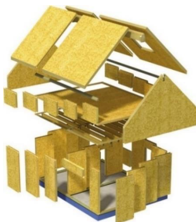
Fig. 31 – Construção em SIP [41]
