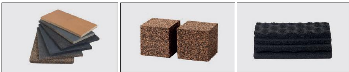
Fig. 25 – Esquerda: Materiais de cortiça e borracha natural; Centro: Aglomerado de cortiça ligada por resina e borracha reciclada; Direita: Materiais de borracha reciclada [22]
