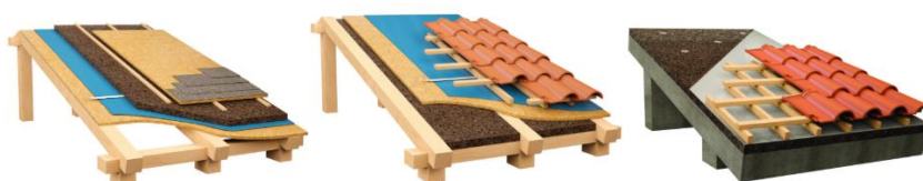
Fig. 72 - Exemplos de aplicação de cortiça (castanho escuro) em coberturas inclinadas [97]
