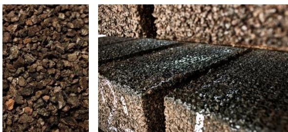
Fig. 9 – Esquerda: Grânulos de cortiça para fabricação de aglomerados; Direita: Blocos de aglomerado puro expandido [20]
