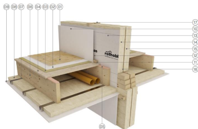
Fig. 48 - Exemplo de aplicação dos underlays na construção leve: 2 - Silent Step Soft; 3 – lã mineral de alta densidade (20mm) [63]
