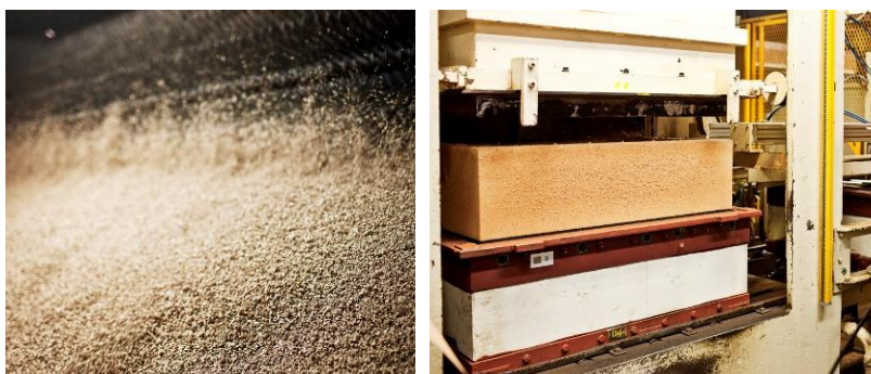
Fig. 11 – Esquerda: Grânulos de cortiça para fabricação de aglomerados compostos; Direita: Moldação de bloco de aglomerado composto [19]
