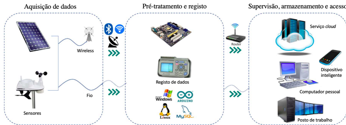
Figura 2.2: Arquitetura básica do sistema de monitorização. Adaptado de [25]
