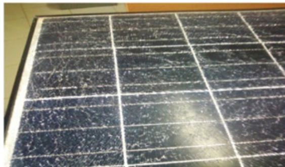
Figura 2.13: Vidro de um módulo FV com quebras e fissuras [77]
