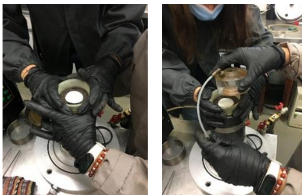
Fig. 4.11 – Colocação do papel de filtro e do topo
