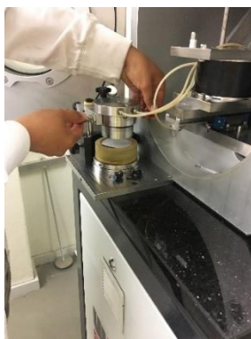
Fig. 4.35 – Colocação do topo da amostra (esta amostra foi compactada através de uma técnica diferente do Moist Tamping , pelo que não foi envolvida por um molde)
