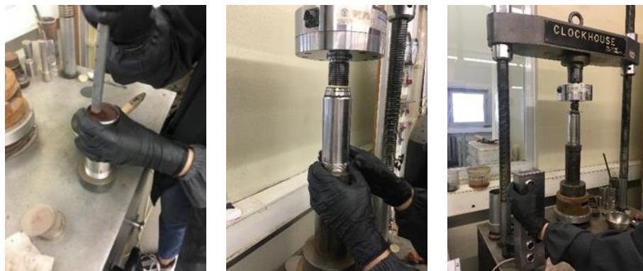
Fig. 4.17 - Compactação do solo com recurso a prensa mecânica
