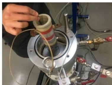
Fig. 4.23 – Compactação de amostra solta pela técnica Moist Tamping no equipamento Triaxial Stress-Path
