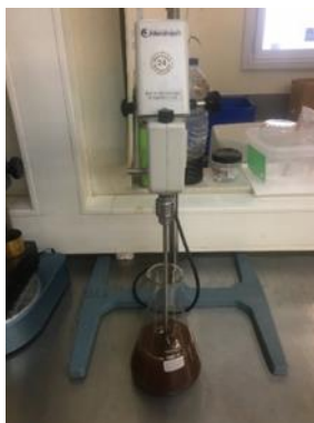
Fig. 4.1 – Lavagem do solo em água destilada e anti-floculante
