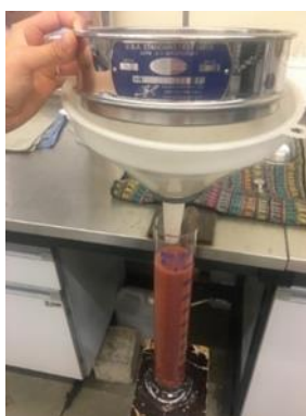
Fig. 4.2 – Separação das frações grossa e fina no peneiro nº200
