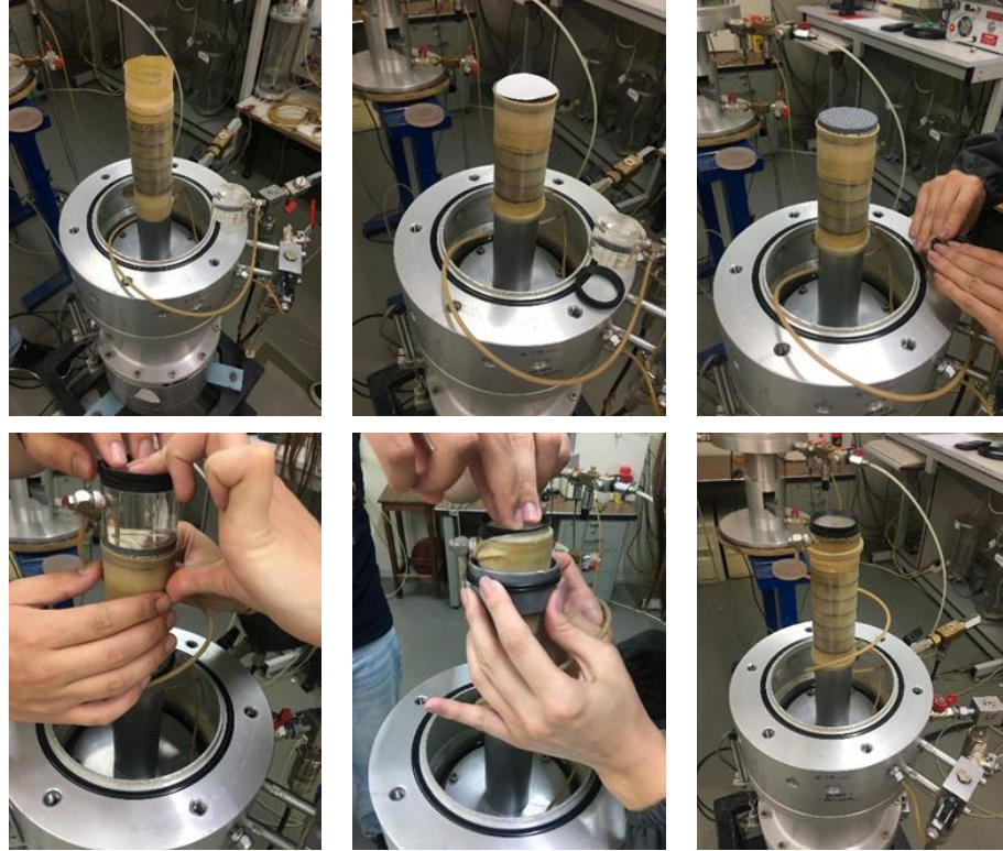
Fig. 4.24 - Montagem da amostra no equipamento Triaxial Stress-Path
