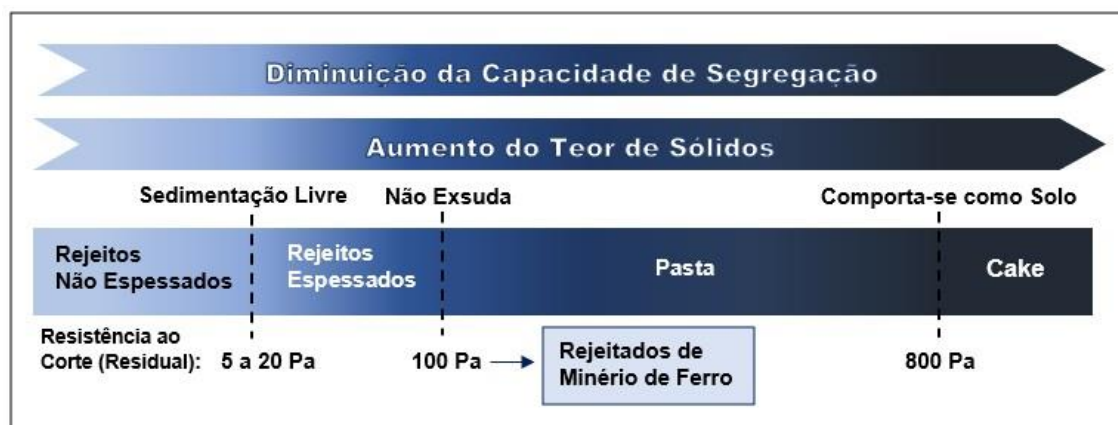
Fig. 2.2 - Espessamento de Rejeitos, adaptado de Raposo (2016)
