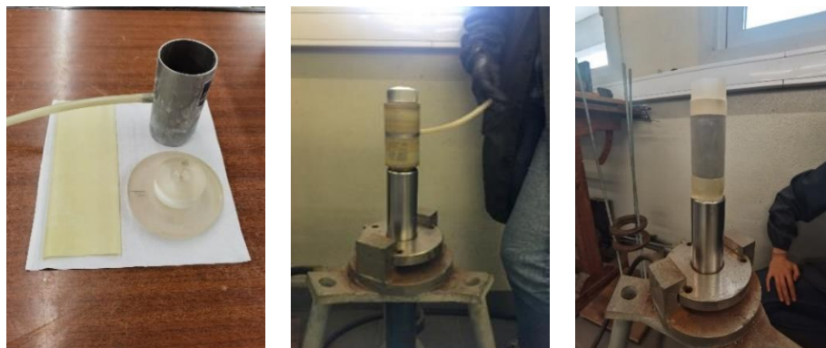
Fig. 4.19 – Colocação da membrana na amostra depois de compactada, através de um molde com sucção
