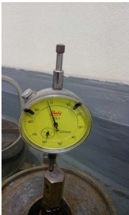
Figura 3.8 - Defletômetro com 0.02mm de retração.
