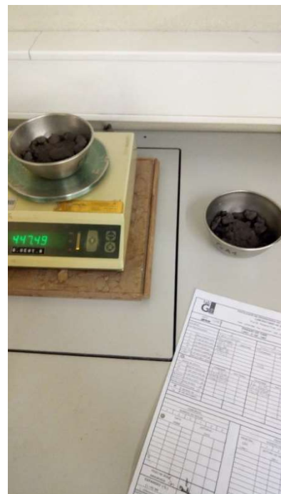
Figura 3.10 - Retirado do peso do material após rasamento do provete.
