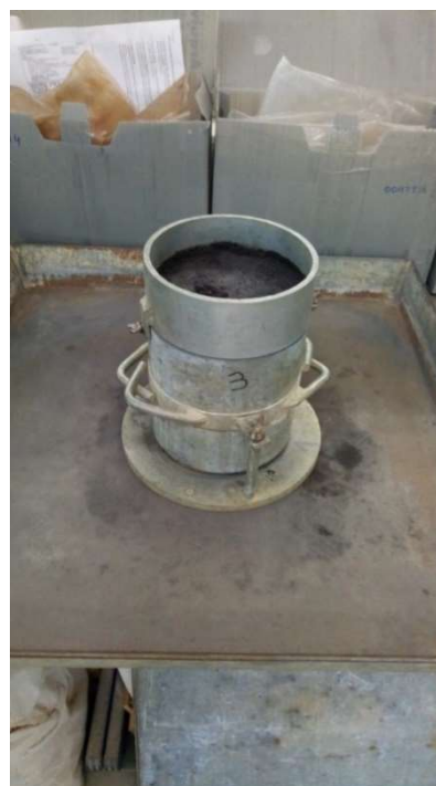
Figura 3.10 - Retirado do peso do material após rasamento do provete.
