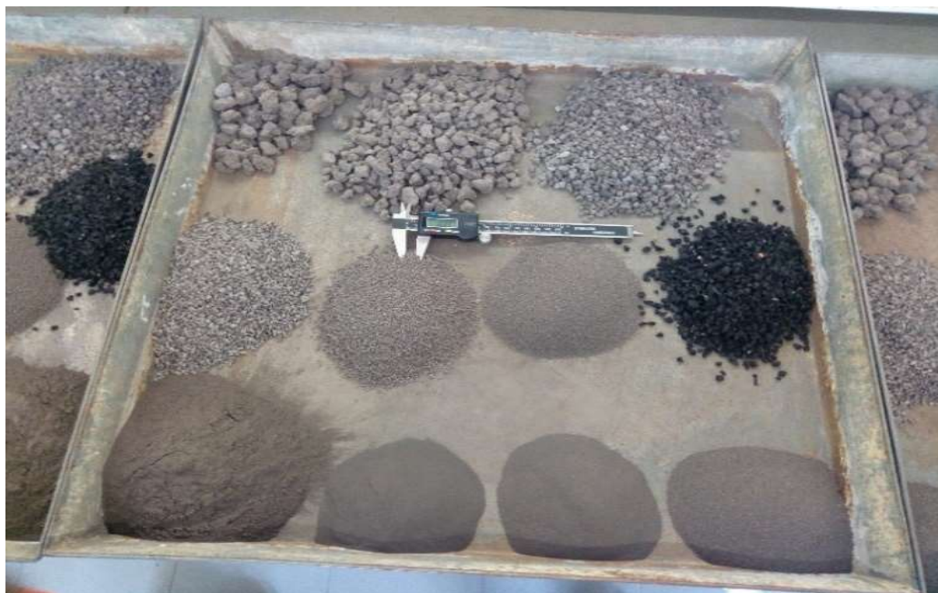
Figura 3.4 - Dimensões das partículas granulométrica de ASIC e borracha.
