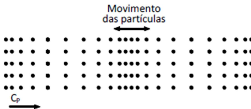
Figura 3.14 - Movimento das partículas das ondas P.
