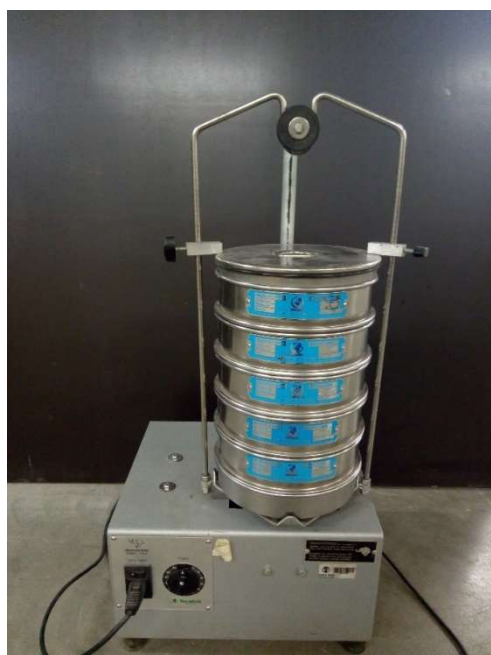
Figura 3.6 - Agitação mecânica do material passado na peneira #4mm.
