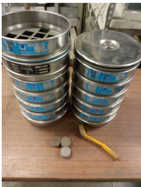
Figura 3.5 - Peneiras com suas respectivas malhas; escova de limpeza; desfragmentador de partículas
