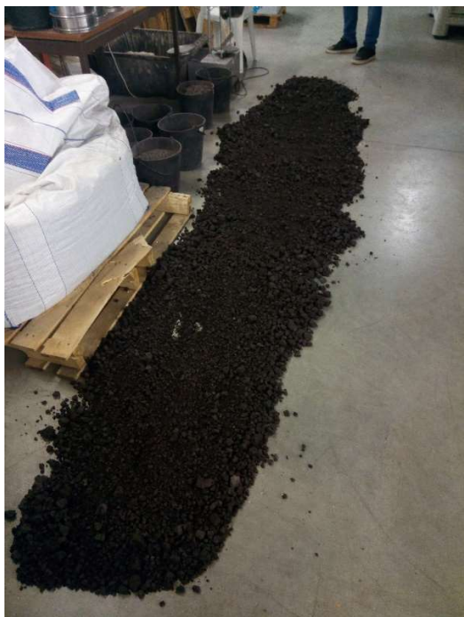
Figura 3.1 - Secagem do ASIC para esquartelamento.
