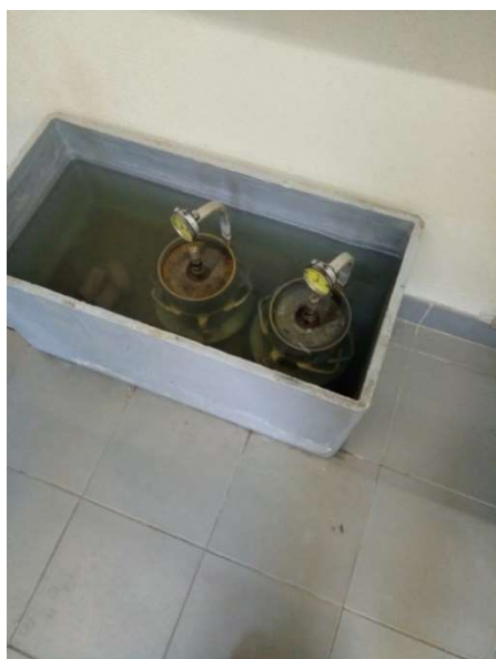
Figura 3.9 - Molde e provete em embeбimento.
