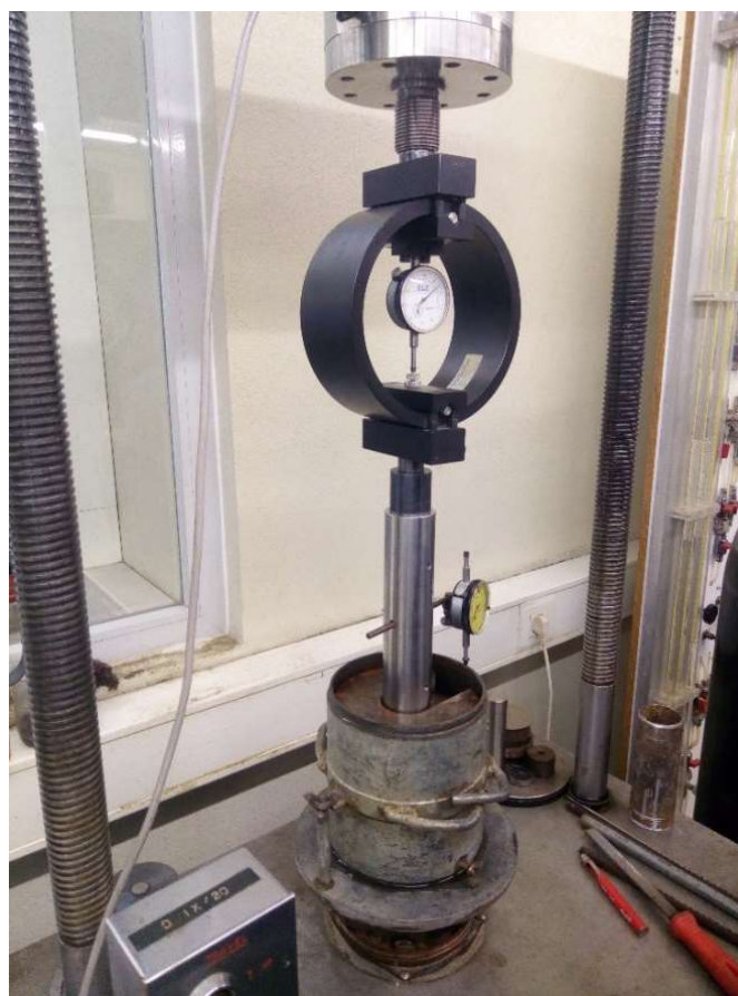
Figura 3.12 - Execução do ensaio de CBR - Prova sendo penetrado pelo pistão.
