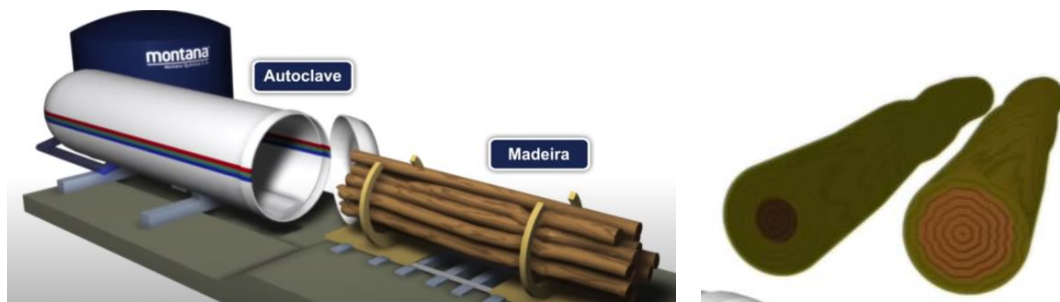
Fig.3.12 – Processo de tratamento do Pinus Autoclavado [25]
