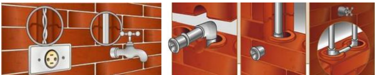
Fig.5.20 – Instalação da rede elétrica e hidráulica [40]
