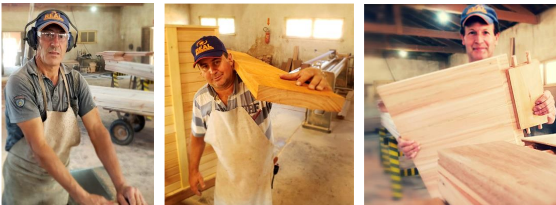
Fig.3.23 – Mão-de-obra especializada e montantes com encaixes da Real Casas Pré-fabricadas [29]
