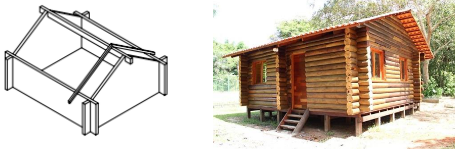
Fig.2.7 – Esquema estrutural [2] e exemplo de uma casa de troncos [16]
