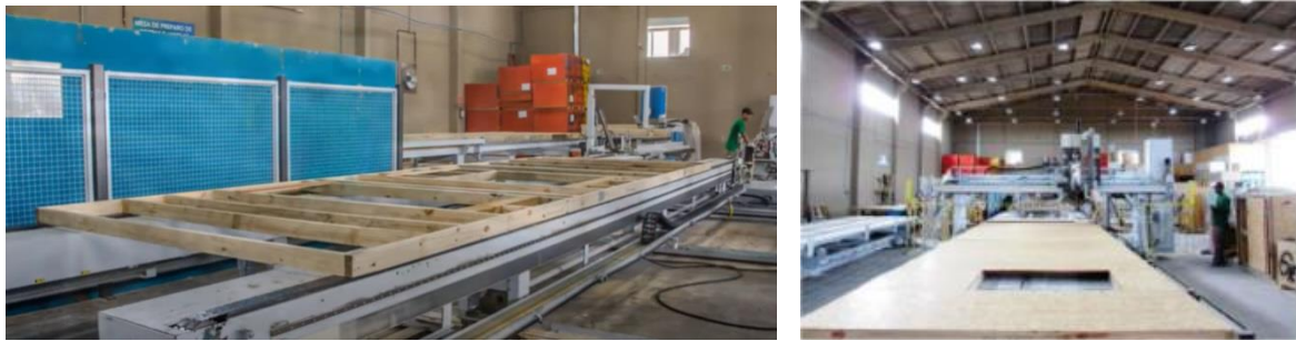
Fig.4.5 – Painéis estruturais com frames montados, OSB chapeado [27]
