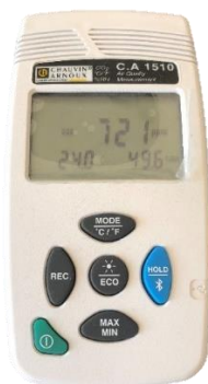
Figura 32 - Dispositivos de medição da concentração de CO 2 , Chauvin&Arnoux CA1510
