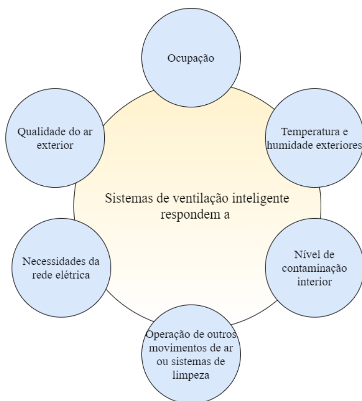
Figura 8 - Parâmetros aos quais a ventilação inteligente responde (adaptado de [10])
