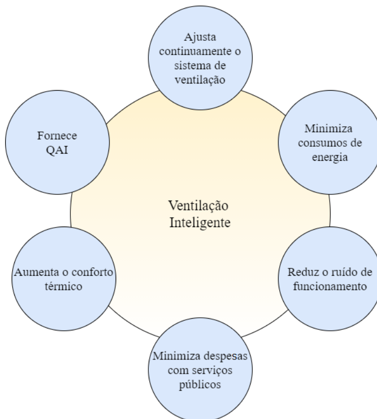
Figura 7 - Principais características da ventilação inteligente (adaptado de [10])
