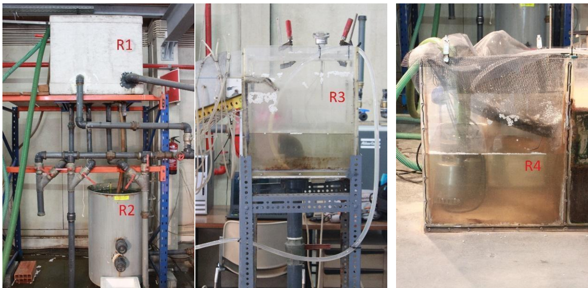
Figura 5 - Reservatórios da instalação.
