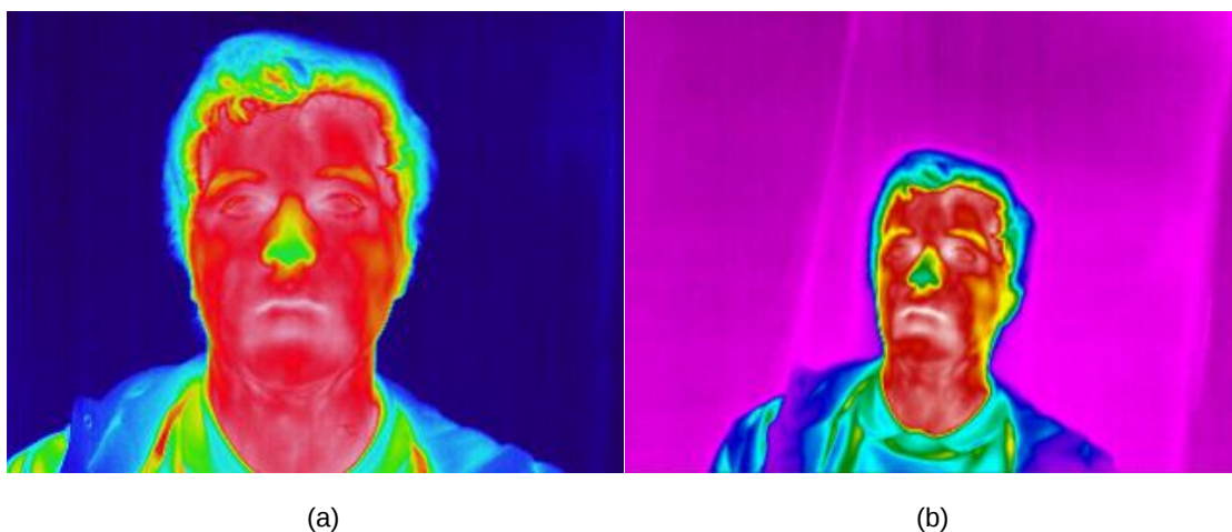
Figura 13 - Imagens térmicas captadas com a: a) Câmara NEC; b) Câmara Fluke
