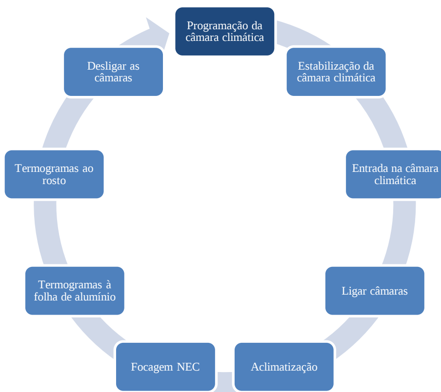
Figura 15 - Esquema do ciclo de ensaios
