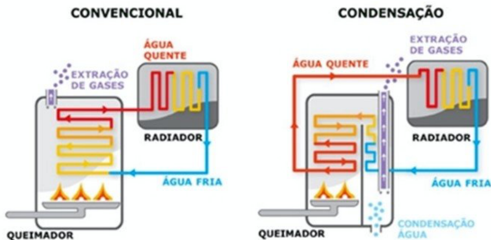
Figura 5.7 - Caldeiras convencionais versus caldeiras de condensação [62]
